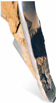
Долото LONG-LIFE після напрацювання 700 га
