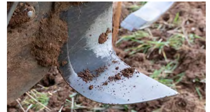
Сравнение обычных крылышек после 44 гектаров
