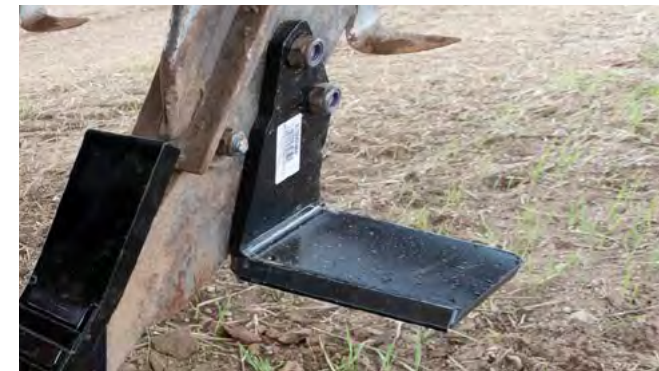
Сравнение крылышек LONG-LIFE после 44 гектаров
