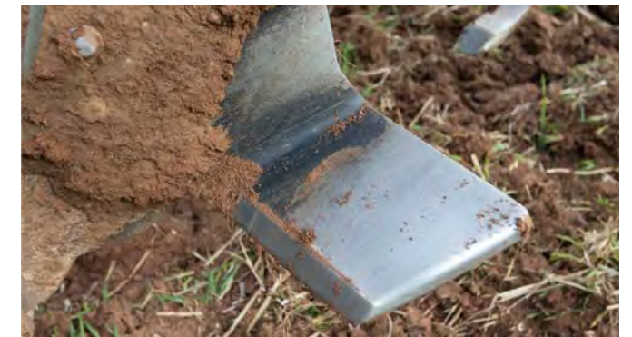
Сравнение крылышек LONG-LIFE после 44 гектаров
