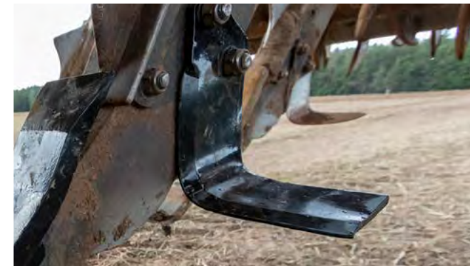
Сравнение обычных крылышек после 44 гектаров
