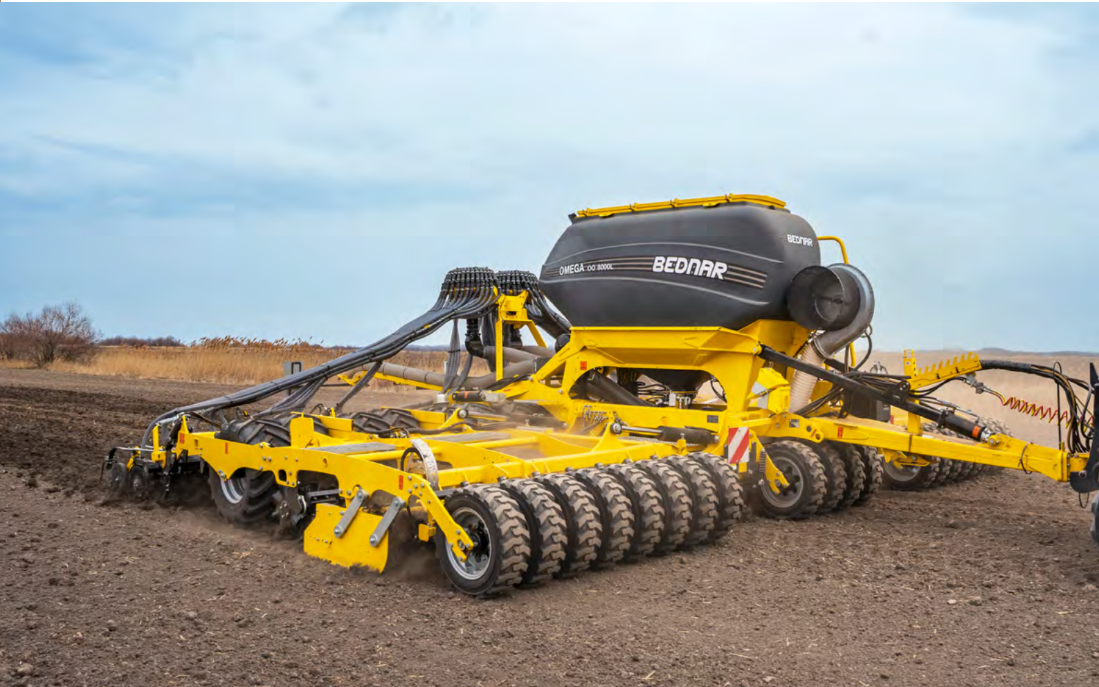
Brăzdarele montate independent funcționează în același rând ca și brăzdarele de semănat din spate.
