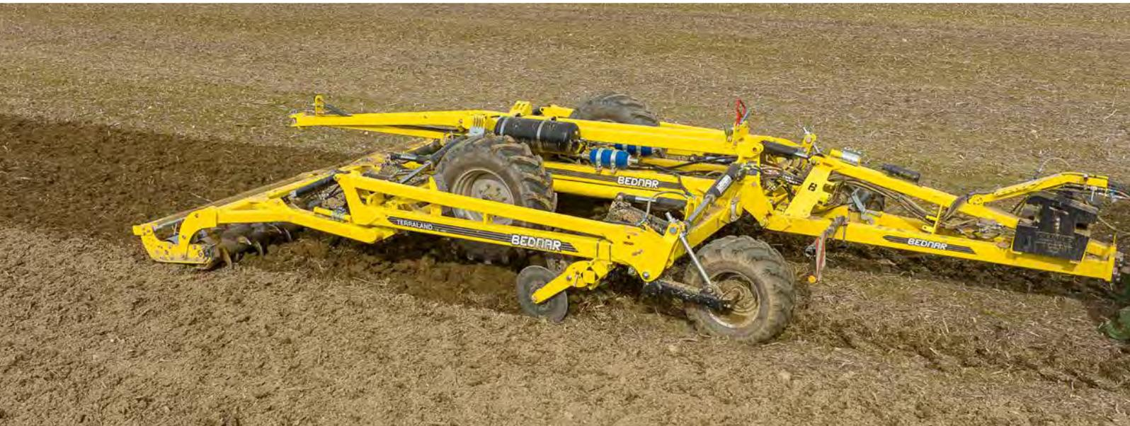
TERRALAND è un coltivatore progettato per la coltivazione profonda del terreno, l'aerazione del profilo del terreno e la disgregazione degli strati di terreno indurito fino a una profondità di 65 centimetri.
