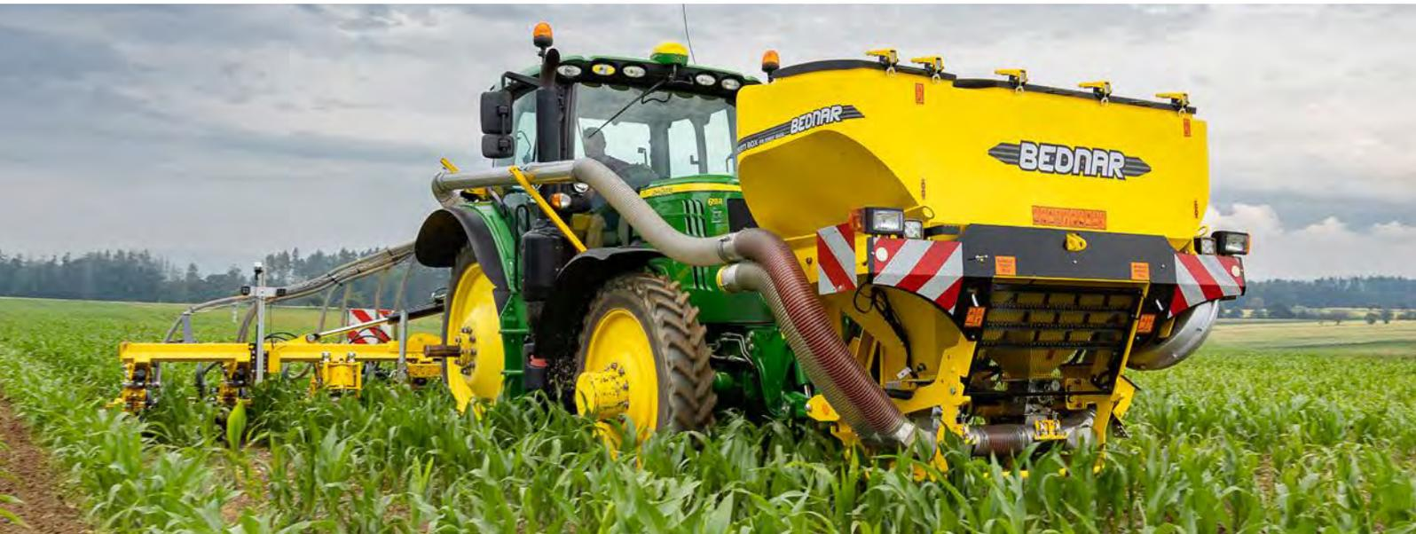
FERTI-BOX e SEED BOX SB rappresentano una gamma di tramogge portate per l'applicazione di fertilizzanti o sementi con un volume da 1 600 a 3 000 litri.
