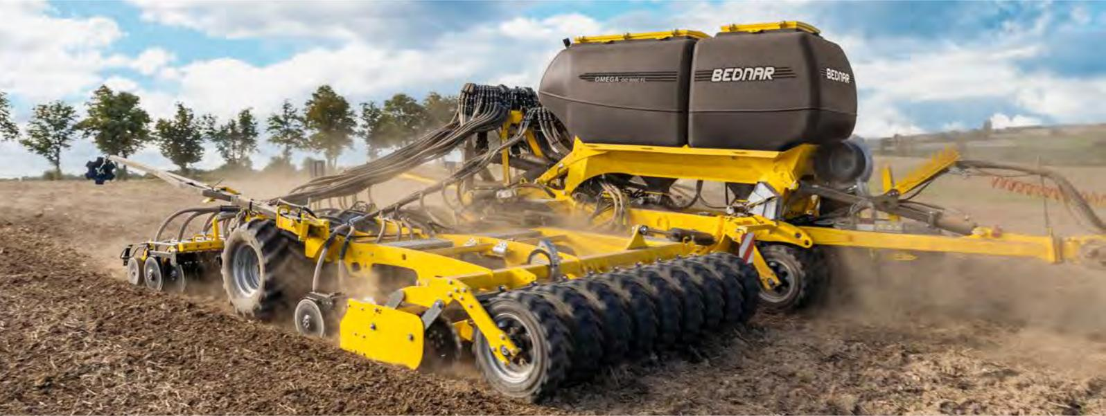
OMEGA è una seminatrice universale con un'ampia gamma di attrezzature che possono essere utilizzate per l'impianto di colture del suolo convenzionali e di minima.
