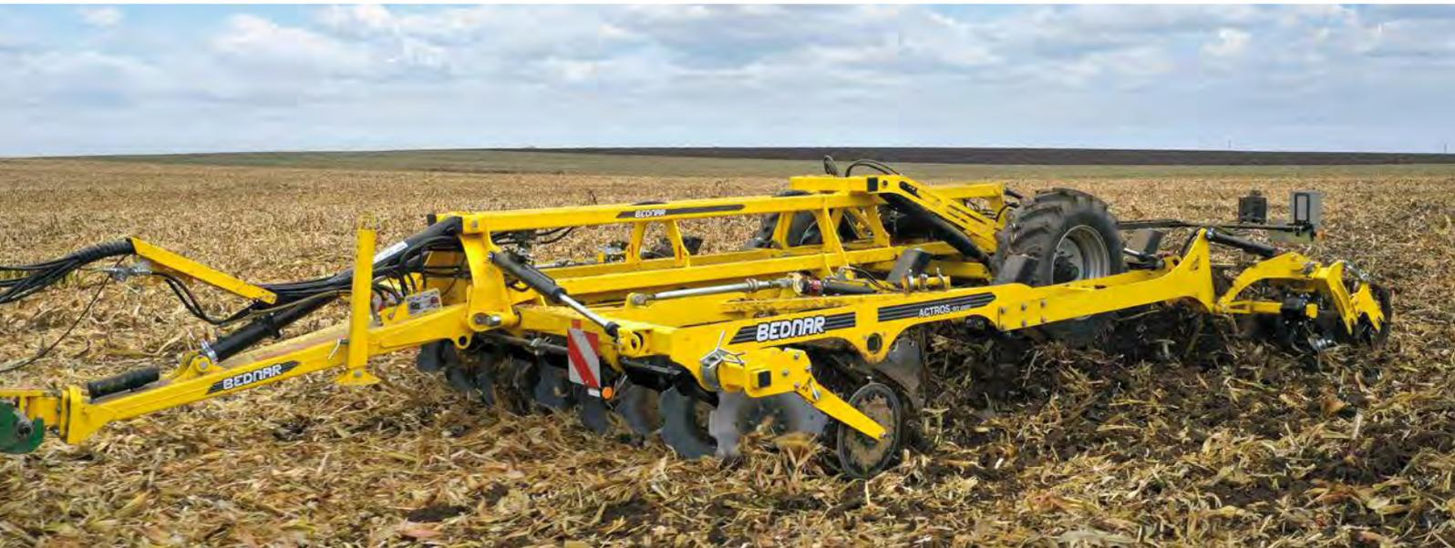
ACTROS RO GEN II è una macchina combinata disco-ancora, adatta alla coltivazione di qualità di campi con grandi quantità di residui colturali grazie all'ampio diametro del disco di 690×6 mm.
