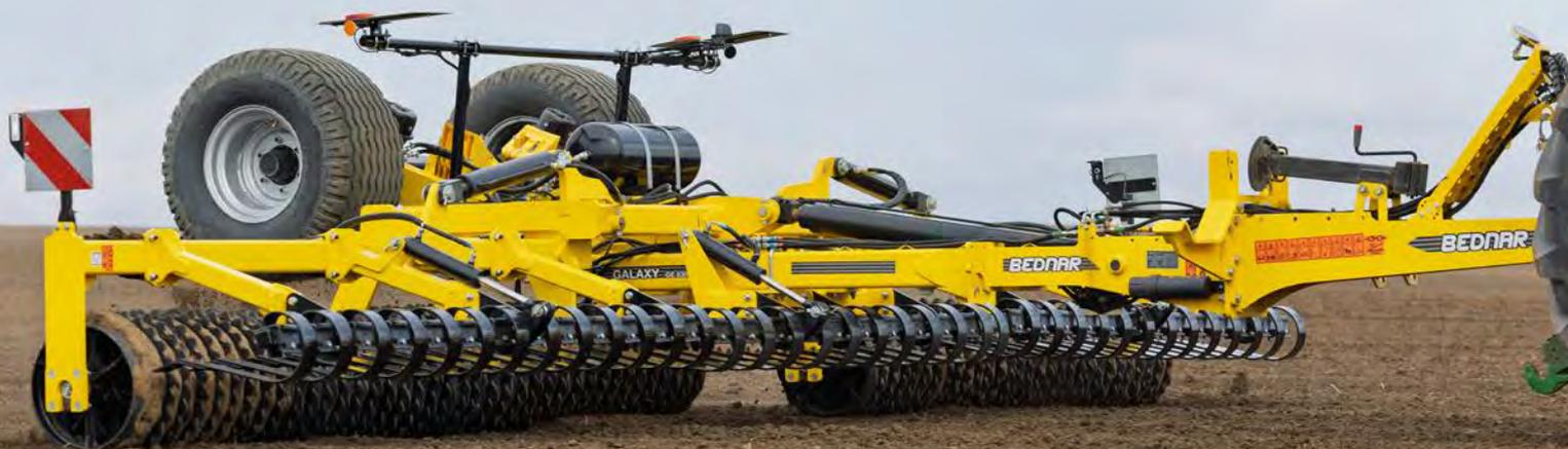
Il rullo trainato GALAXY GE sono utilizzati per la frantumazione di qualità delle zolle e la chiusura del profilo posteriore del terreno. CADDY CD è un carrello porta attrezzi universale da collegare ai trattori senza l'attacco a tre punti.
