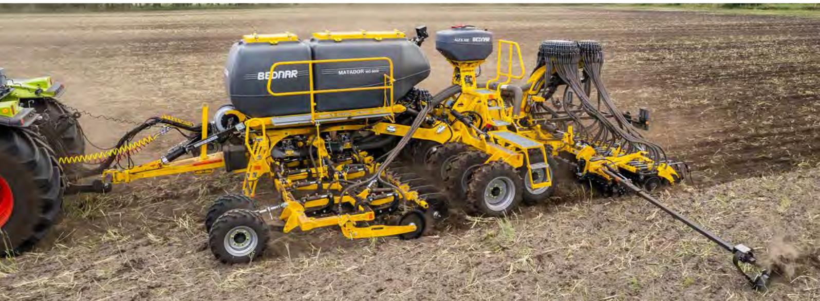
MATADOR MO è una seminatrice appositamente progettata per la tecnologia di lavorazione del terreno a strisce. La seminatrice è dotata di un attacco a tre punti che offre l'aggregazione con la barra di semina CORSA CN / GIRONA GN o con una seminatrice per la semina di precisione.
