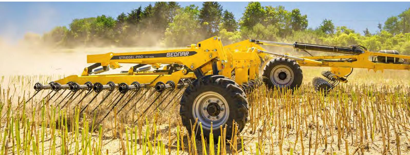
STRIEGEL-PRO è un erpice a molle da campo progettato per la gestione dei residui post-raccolta, per la lavorazione poco profonda, per l'apertura del terreno in primavera o per l'aerazione di prati e cereali permanenti.
