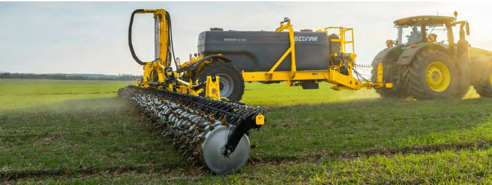
NEVEON EE è un applicatore trainato composto da un serbatoio (FERTI-TANK FT 8000) e da robusti bracci con ruote di applicazione. NEVEON EE è stato sviluppato appositamente per l'applicazione di fertilizzanti liquidi, ma consente anche l'applicazione di batteri, insetticidi o erbicidi.
