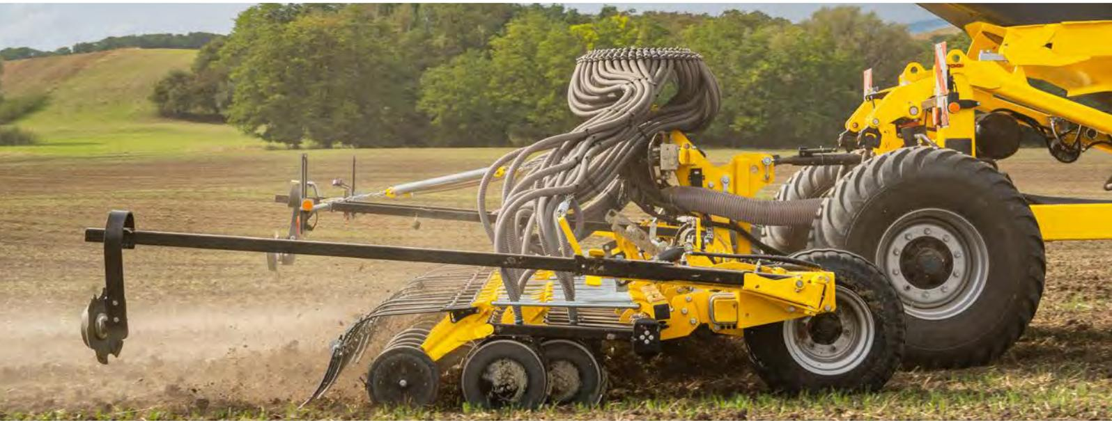
CORSA CN è una barra di semina portata adatta all'aggregazione con trattori di bassa potenza. CORSA CN è progettata principalmente per l'impianto di colture in terreni preparati.
