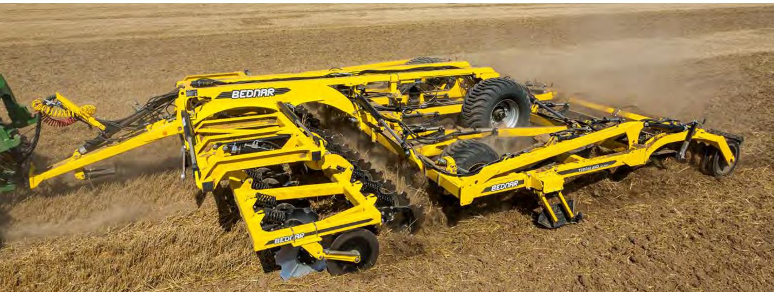
TERRALAND DO è un coltivatore combinato adatto alla lavorazione di grandi quantità di residui colturali dopo il raccolto. L'efficiente combinazione di una sezione a disco e una ad ancore garantisce una miscelazione e un allentamento di qualità fino a 45 cm.
