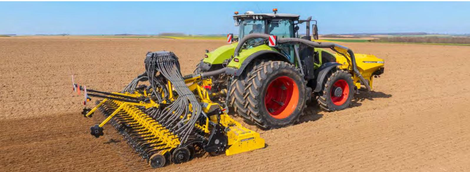
KATARA KN\_S è una seminatrice combinata portata, particolarmente adatta per l'impianto di colture con tecnologia convenzionale di lavorazione del terreno, in combinazione con il serbatoio anteriore BEDNAR SEED BOX SB o FERTI-BOX FB\_F.
