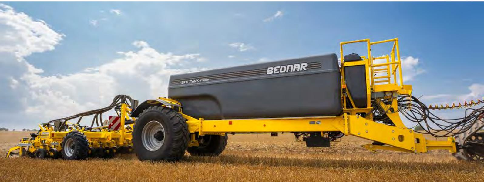
FERTI-TANK FT è un carro cisterna trainato per l'applicazione di fertilizzanti liquidi in combinazione con macchine per la lavorazione del terreno e la semina.
