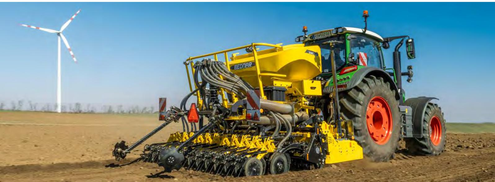
SONIQ ON è una seminatrice combinata adatta soprattutto per la creazione di colture con tecnologia convenzionale di lavorazione del terreno. SONIQ ON ha un unico serbatoio (modello ON), posizionato sopra i coltri rotanti. La barra di semina è dotata di coltri di semina a doppio disco.
