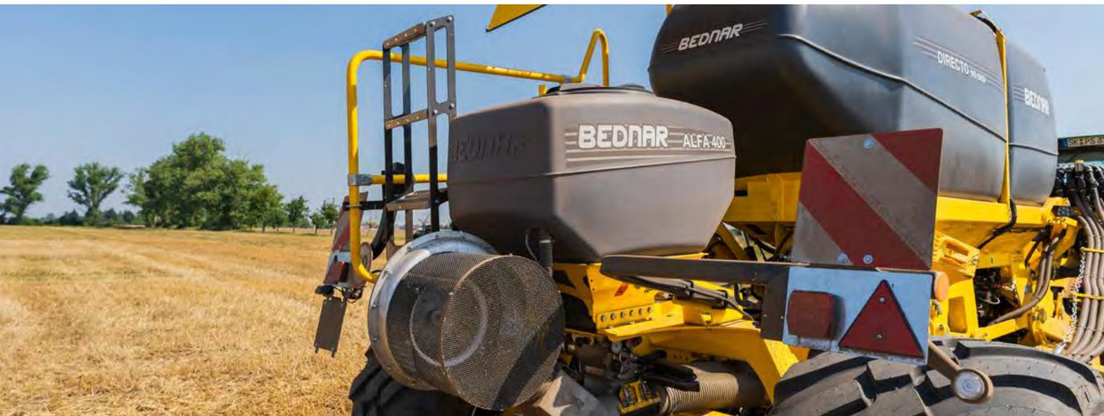
ALFA DRILL è un'unità di semina progettata per la semina di colture intercalari, per la semina aggiuntiva di erbe o per l'applicazione di fertilizzanti o microgranulati in un'unica passata, in combinazione con macchine per la coltivazione del terreno, la preparazione del letto di semina e la semina.
