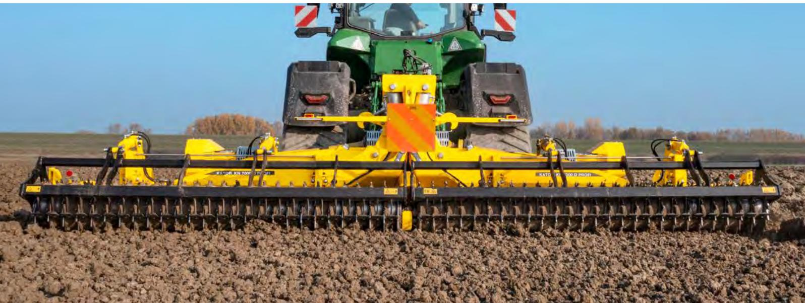
KATOR KN è un erpice rotante con parti di lavoro attive. È ideale per la preparazione del letto di semina in terreni pesanti, duri, secchi e difficili da coltivare.
