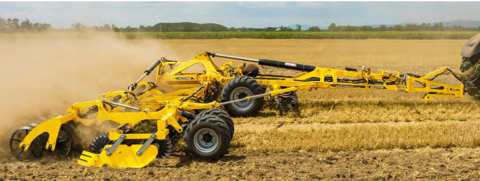
SWIFTERDISC è un coltivatore a dischi universale, adatto per una coltivazione veloce e di qualità delle stoppie fino a 14 centimetri di profondità, nonché per la preparazione del letto di semina.
