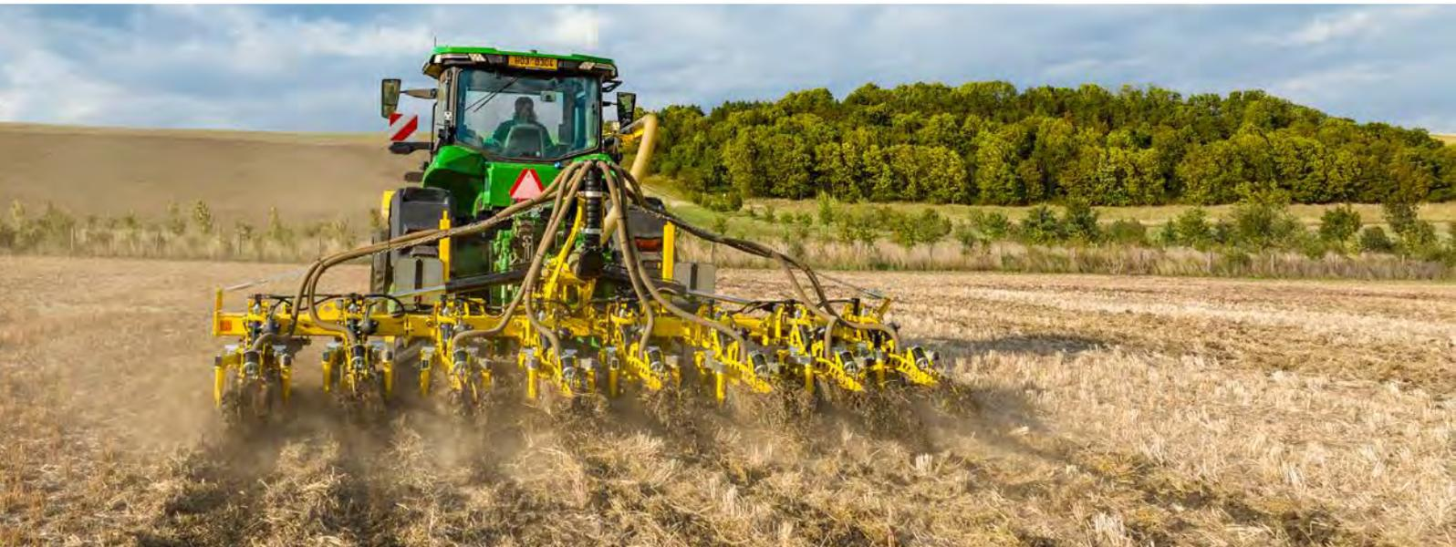
STRIP-MASTER è un coltivatore ad ancore progettato per la lavorazione a strisce del terreno fino a una profondità di 35 centimetri. La distanza tra le file delle unità di coltivazione può essere impostata tra 45 e 80 centimetri.
