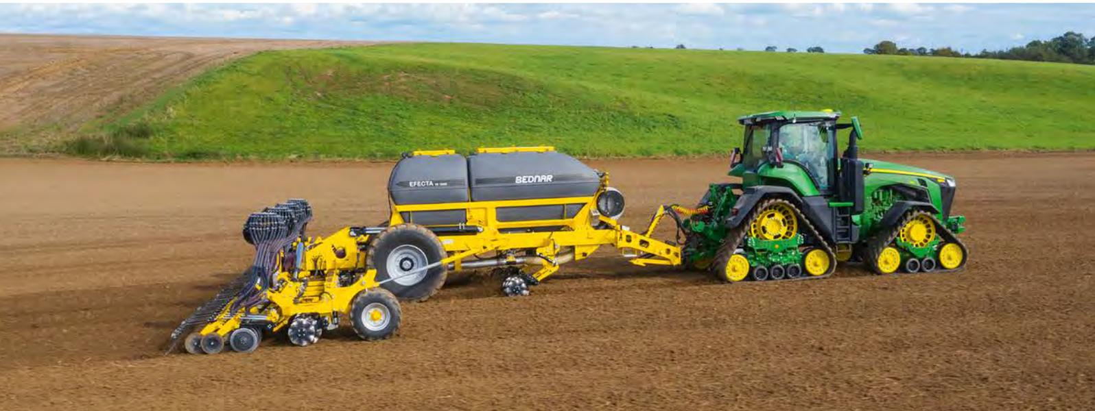
EFACTA CE è una seminatrice ampia e altamente efficiente con una larghezza di lavoro di 12 metri, progettata per ottenere elevate produzioni giornaliere. Sulla macchina possono essere installati quattro tipi di attrezzature frontali.
