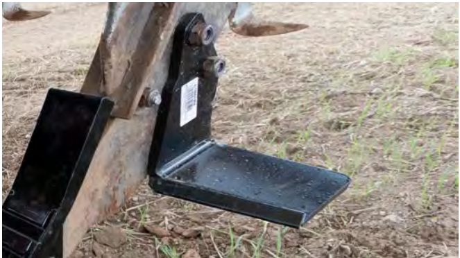
Comparación de una aleta Long Life tras 44 hectáreas
