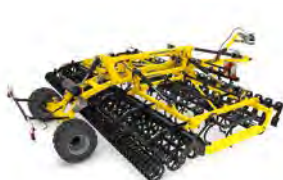
SWIFTER magágy-előkészítő kompaktor
