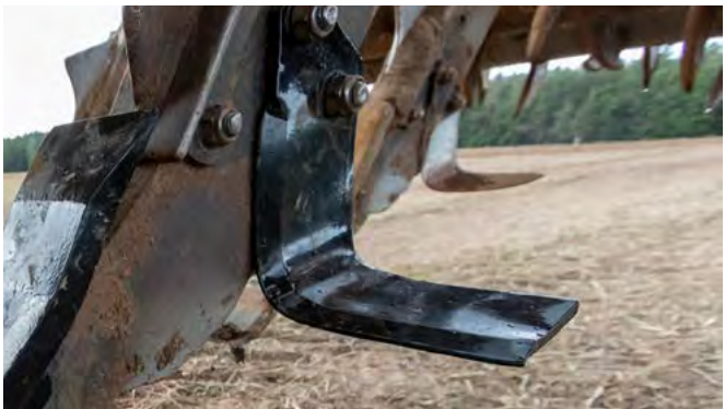
A normál szárnyak állapota 44 hektár megművelését követően
