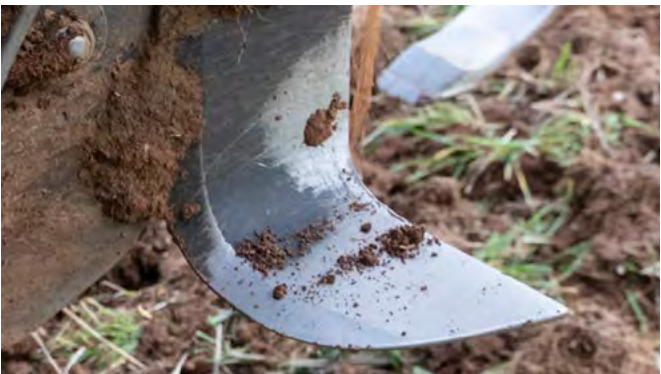
A normál szárnyak állapota 44 hektár megművelését követően
