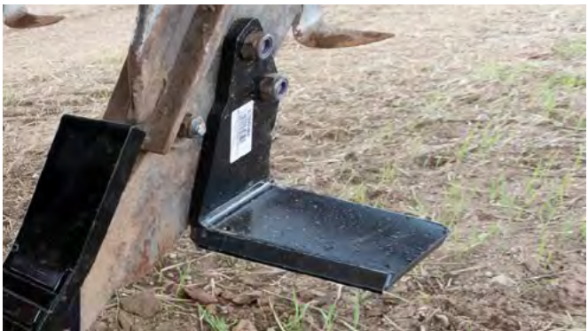
A LONG-LIFE szárnyak állapota 44 hektár megművelését követően
