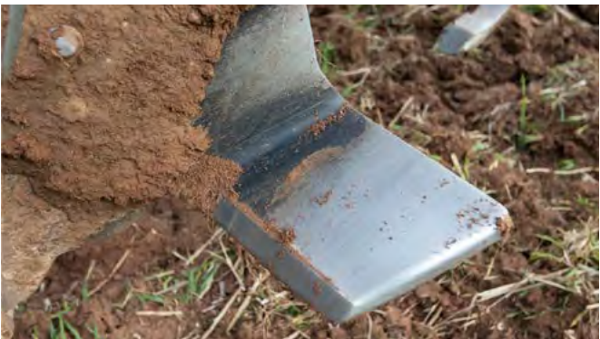
A LONG-LIFE szárnyak állapota 44 hektár megművelését követően
