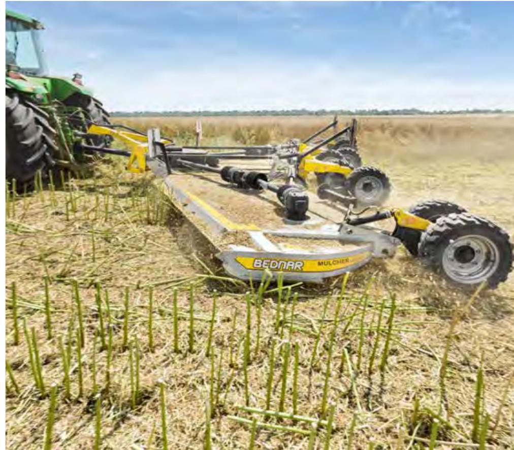
Si vous n'avez pas desséché les résidus de colza, il sera nécessaire de passer sur le champ avec un broyeur qui broiera les résidus coriaces et les épandra ensuite uniformément sur le terrain.
