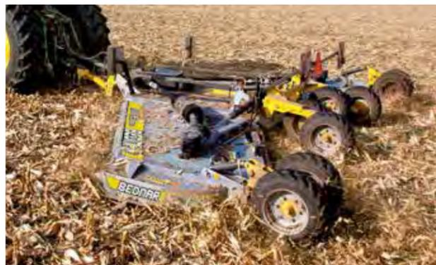
Les broyeurs BEDNAR MULCHER sont des machines qui ont été zinguées à chaud et qui, grâce à des éléments de conception ayant été parfaitement testés (comme le système de couteaux à maïs, le contre-couteau avant, la barrière anti-lignes, les tôles de protection blindées, les essieux de cheminement, etc.) sont capables de broyer d'importantes quantités de résidus de moissons pour les transformer en particules de 3 à 5 cm.
