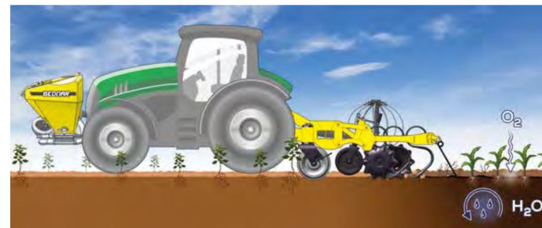
L'association d'une bineuse entre rangs Row-Master et d'une trémie à engrais minéraux FERTI-BOX.
