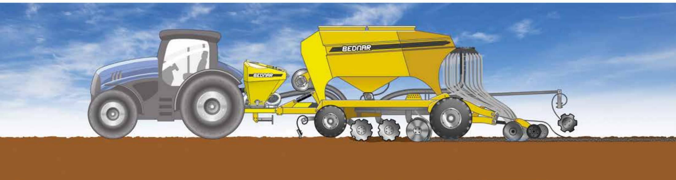
Le principal avantage procuré par l'attelage d'une trémie FERTI-BOX à un semoir OMEGA est que vous pourrez appliquer de l'engrais de démarrage destiné aux plantes printanières. Pour ce qui est des plantes d'hiver, le semoir reste léger et simple.
