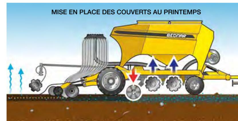
Au printemps, le semoir OMEGA OO peut travailler avec sa section de disques totalement relevée. Au printemps, sur les terres lourdes, les disques forment des particules de terre indésirables. Le travail des disques, soit le réchauffement et l'oxygénation de la couche supérieure du profil du sol, sera réalisé par les coulters. Il en résultera un couvert parfaitement mis en place et une germination excellente et uniforme sur l'intégralité de la parcelle.
