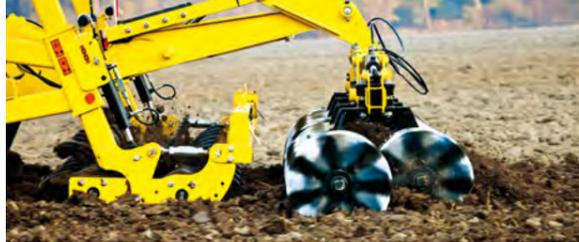
La section de disques Cutter est formée de 2 rangées de disques, d'un diamètre de 520x5 mm, placés en quinconce. Ces disques coupent, retournent la matière végétale et nivellent la surface en prévision du passage du semoir. Leur disposition en quinconce garantit un effet autonettoyant en cas de travail dans des conditions très humides.
