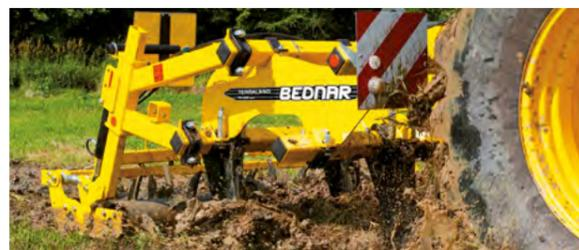
La conception de la machine TERRALAND TN lui permet également de travailler dans des conditions très humides. L'action de la machine permettra justement d'améliorer l'évacuation de l'eau. Le terrain sèchera donc rapidement, s'assainira, ce qui permettra de l'exploiter plus rapidement.
