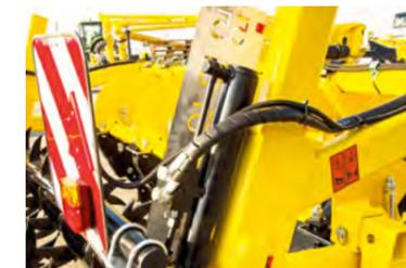
Sur les machines TERRALAND TN et TN\_PROFI, le réglage de la profondeur de travail est hydraulique et se réalise au niveau du double rouleau arrière et des bras du tracteur, le tout, depuis le confort de la cabine.
