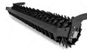
Un rouleau qui a un excellent effet broyeur et qui est idéal dans les terres lourdes. Ce rouleau comporte également des racloirs. Le diamètre du rouleau est de 550 mm. Masse : 110 kg/m.
