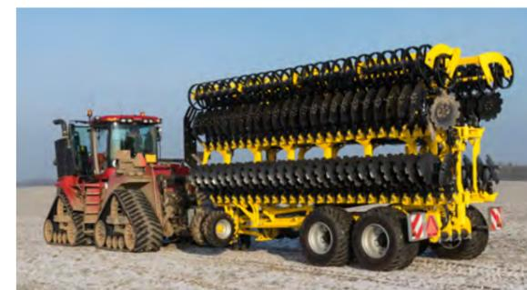
La machine ATLAS AE\_PROFI se replie vers l'avant, sur le timon. En position de transport, la largeur de la machine est de 3 m et sa hauteur de transport est de 4 m – doubles rouleaux V-ring ou U-ring inclus. En position de transport, la machine ATLAS AE\_PROFI est stable et elle pourra être facilement transportée entre les différentes parcelles.
