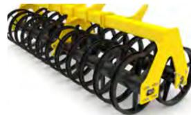
Rouleau à deux rangées, en acier, proposant un effet autonettoyant, un excellent effet broyeur et une faible adhérence grâce au profil en U du bandage.
