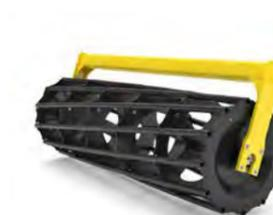
Der Rohrpacker besteht aus massiven Stahlrohren. Geeignet für intensive Krümelung, vorausgesetzt, dass eine hohe Umfangsgeschwindigkeit erreicht wird. Der Packer eignet sich vor allem für leichte Böden.
