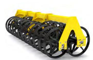
Der Doppel-V-RING ist ein Ringpacker mit einem „V“-Ringprofil. Dies gewährleistet eine geringe Haftung der Teile auf dem Packer. Die Ringe sind ineinander gesteckt, wodurch Verstopfungen verhindert werden.
