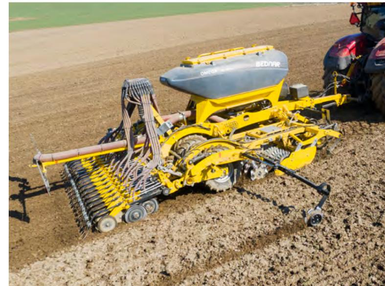
Bei einer Arbeit ohne Navigation kann die Drillmaschine OMEGA mit seitlichen hydraulisch gesteuerten Spuranzeigern ausgestattet werden.
