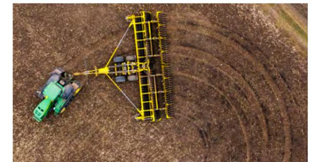
Die Scheibenegge ATLAS AE\_PROFI hat eine große Arbeitsbreite. Dank ihrer Konstruktion ist sie sehr gut manövrierbar, und dies auch am Vorgewende. Die Maschine wendet auf den hinteren Walzen und den vorderen Stützrädern. Diese Lösung beseitigt die negativen Folgen der Belastung der Aufhängung und der Gewichtsverlagerung des Traktors am Vorgewende.
