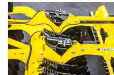
Die Einstellung der Arbeitstiefe der Maschine geschieht einfach und bequem über Hydroclips an den hinteren hydraulischen Zylindern, die den Rahmen der Maschine mit dem Rahmen der Verfestigungs- und Krümelwalzen verbinden.
