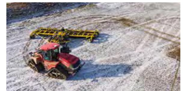
Die Scheibenegge ATLAS AE\_PROFI hat eine große Arbeitsbreite. Dank ihrer Konstruktion ist sie sehr gut manövrierbar, und dies auch am Vorgewende. Die Maschine wendet auf den hinteren Walzen und den vorderen Stützrädern. Diese Lösung beseitigt die negativen Folgen der Belastung der Aufhängung und der Gewichtsverlagerung des Traktors am Vorgewende.
