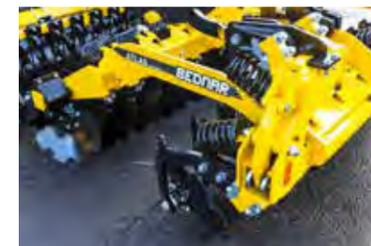
Bei dem 3-Meter-Modell werden die Scheiben mechanisch oder in einer teureren Variante hydraulisch einge-klappt. Das hydraulische Einklappen ist sehr bequem, insbesondere wenn die Maschine mehrmals täglich auf unterschiedlichen Feldern arbeiten muss. Durch diese Lösung entspricht die Maschine den Anforderungen an einen Transport auf der Straße. Die Transportbreite ist bis zu 3 m. Nach Ausklappen der Seitenscheiben hat die Maschine eine Arbeitsbreite von 3 m.
