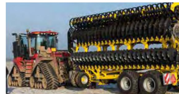
Die Maschine ATLAS AE wird nach vorn auf die Deichsel eingeklappt. In der Transportstellung hat die Maschine eine Breite von 3 m und eine Höhe von 4 m, und dies einschließlich der Doppelwalzen V-Ring oder U-Ring. ATLAS AE ist in der Transportstellung stabil und lässt sich sehr gut zwischen den einzelnen Feldern überführen.
