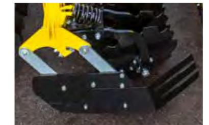
Die Maschine kann mit Deflektoren ausgestattet werden, die den Boden niederschlagen, so dass die Maschine problemlos arbeiten kann und nicht verstopft.
