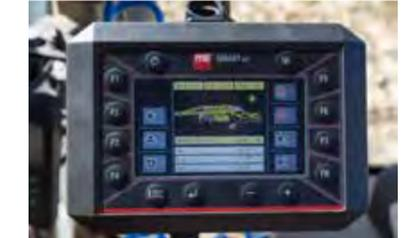
ATLAS kann vollständig hydraulisch aus der Traktorkabine gesteuert werden. Die Arbeitstiefe kann aus dem Traktor über einen einfachen Bildschirm eingestellt werden.
