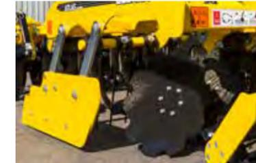
Die hohe Bodenfreiheit des Rahmens in Kombination mit der durchdachten Positionierung der Scheiben ermöglicht Ihnen eine hochwertige Bodenbearbeitung auch unter anspruchsvollen Bedingungen, und dies ebenfalls bei einer Verarbeitung von Pflanzen zur Gründüngung.
