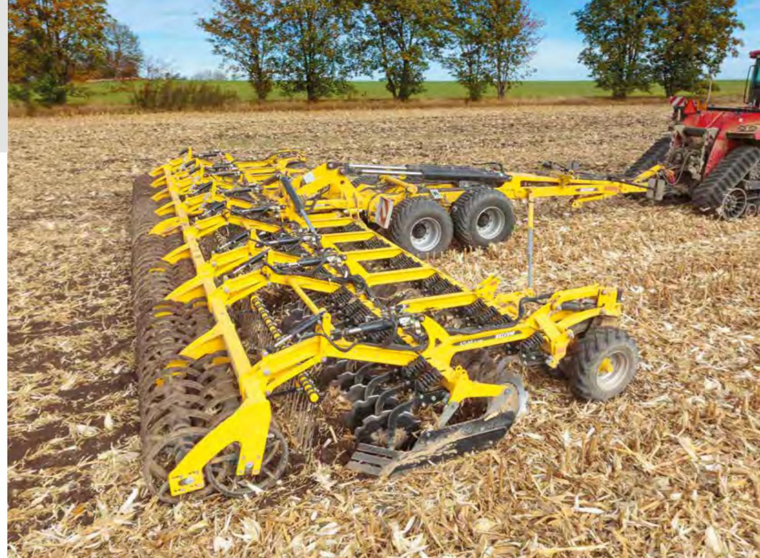
**BEDNAR ATLAS AE\_PROFI ist eine schwere gezogene Kurzscheibenegge** mit einem breiten Arbeitsbereich und einer robusten Konstruktion, die für die Stoppelbearbeitung mit einer größeren Menge von Ernterückständen bestimmt ist. Die Gesamtkonzeption der Maschine ermöglicht eine Arbeit in hoher Geschwindigkeit. Gemeinsam mit der großen Arbeitsbreite werden so enorme Tagesleistungen erreicht.
