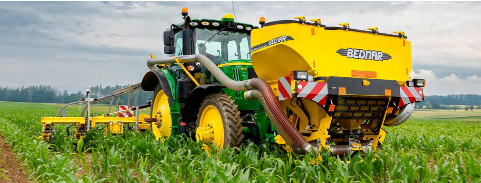
FERTI-BOX a SEED BOX SB představuje modelovou řadu nesených zásobníků pro aplikaci hnojiva nebo osiva s objemem od 1 600 do 3 000 litrů.
