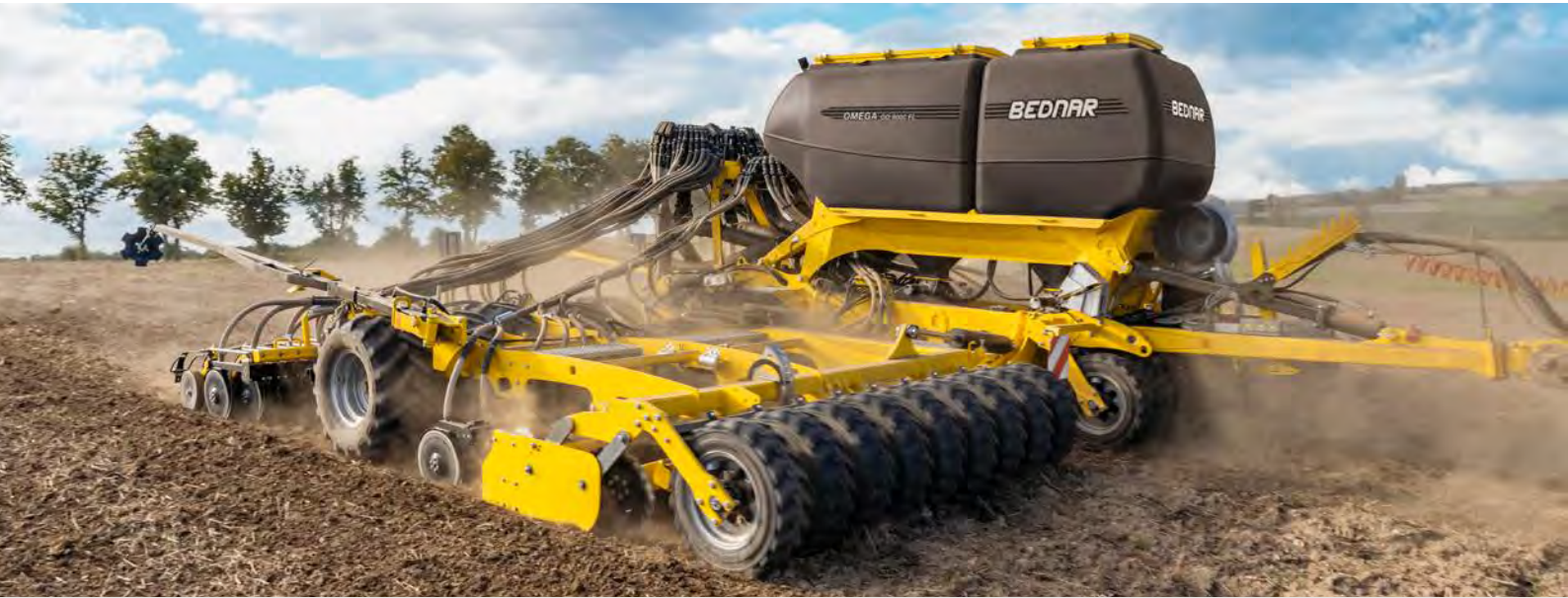
OMEGA je univerzální secí stroj s širokou škálou výbavy, který lze využít pro zakládání porostů v podmínkách konvenční i minimalizační technologie zpracování půdy.
