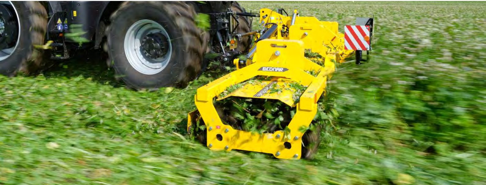
SPEED CHOP SC_F je nesený řezací válec, který má mnoho krátkých nožů, aby bylo dosaženo nejagresivnějšího řezu rostlinného materiálu. Vhodné doplnění no-till technologie.
