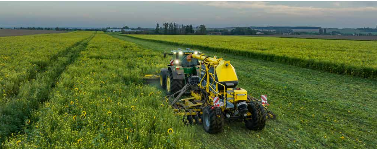
Přímé setí secím strojem DIRECTO do směsky slunečnice, pohanky a hořčice
