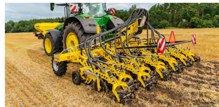
Řádkový kypřič STRIP-MASTER EN lze agregovat s čelním zásobníkem FERTI-BOX FB_F o objemu 1900 nebo 2200 litrů.
