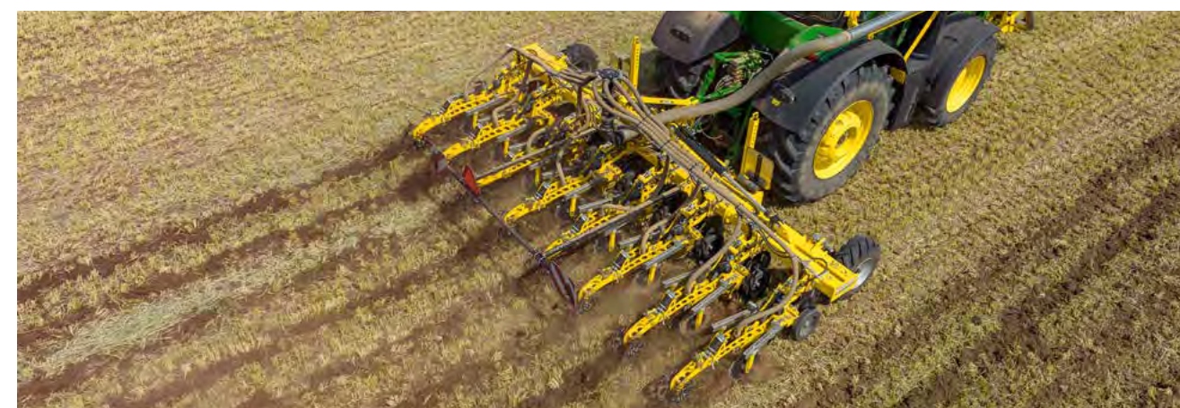
Offsetové uspořádání kultivačních jednotek u strojů s dvanácti jednotkami umožňuje vysokou průchodnost i na pozemcích s velkým množstvím posklizňových zbytků.
