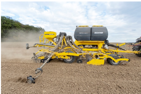
Новая сеялка OMEGA OO_FL позволяет вносить удобрения между семенами или вместе с семенами
