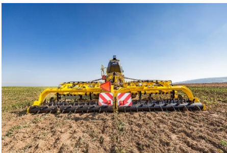
«TERRASTRIP ZN 8R / 75» предназначен для эффективной и объективной обработки почвы, что снижает затраты при одновременном повышении урожайности отдельных пропашных культур.
