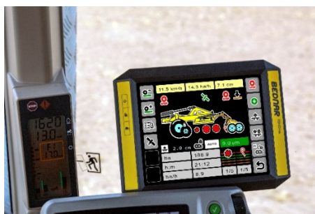
Электрогидравлическое управление машиной «EH-Set» через стандарт «ISOBUS»
