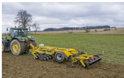
«ACTROS RO» имеет дополнительные задние уплотнители в зависимости от типа почвы
