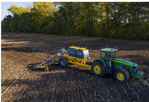
Трехточечное крепление категории IV для легкого соединения пневматического бункера «COMBO SYSTEM CS» с другими машинами «BEDNAR»
