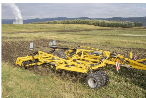
Интегрированная ось обеспечивает быстрый поворот на поворотной полосе
