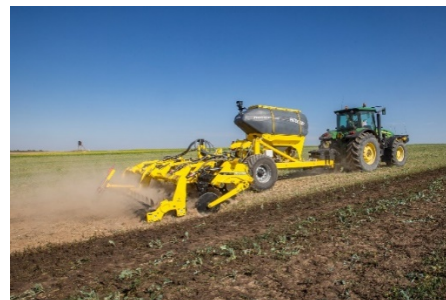
Рыхлительный культиватор для глубокой обработки почвы в сочетании с бункером для удобрений «FERTI-CASRT FC»
