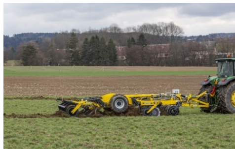
Комбинированный культиватор с двумя рядами дисков 660 x 6 мм и двумя рядами сошников с массивной пружинной защитой
