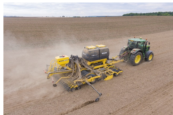
Точное размещение семян на одинаковой глубине по всей ширине машины благодаря системе PSP
