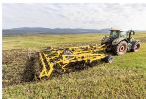
3 или 4 ряда сошников с постоянной геометрией легко работают даже в экстремальных условиях
