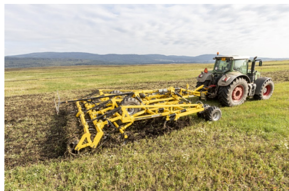
3 sau 4 rânduri de dinți cu geometrie constantă pentru lucrul ușor chiar și în condiții extreme
