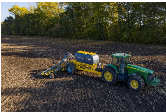
Bară de tracțiune cu prindere în 3 puncte, categoria IV, pentru conectarea ușoară a buncărului presurizat COMBO SYSTEM CS cu alte utilaje BEDNAR
