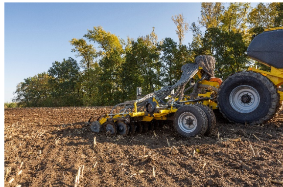
Reglarea adâncimii de lucru și a presiunii pe brăzdare se face hidraulic
