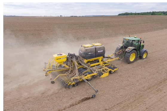
Plasarea precisă a semințelor la o adâncime identică pe întreaga lățime a semănătorii, datorită sistemului PSP
