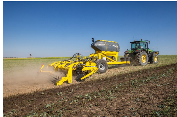
Scarificator pentru lucrarea solului în benzi în adâncime în agregat cu buncărul pentru fertilizare FERTI-CART FC
