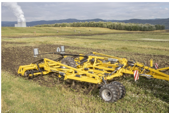
Zintegrowana oś zapewnia szybkie nawracanie na uwrociach
