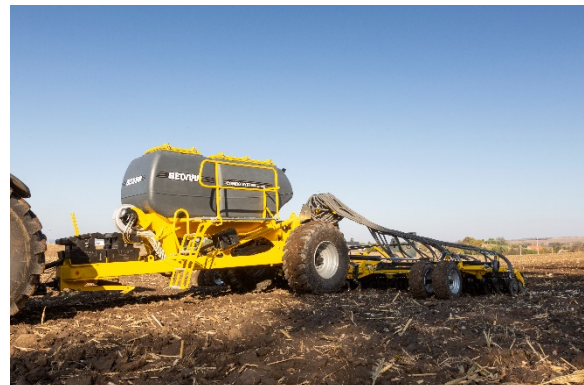
Podwójny ciśnieniowy zbiornik połączony z sekcją siewną CORSA CN
