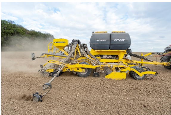
Nowy siewnik OMEGA OO_FL może siać nawóz w międzyrzędziu lub razem z nasionami
