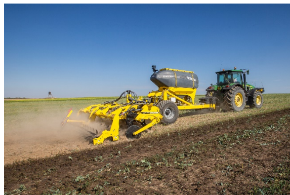
Pług dłutowy strip-till zagregatowany ze zbiornikiem nawozowym FERTI-CASRT FC
