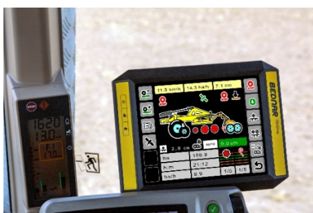
EH-elektrohydrauliczna kontrola maszyny poprzez ISOBUS standard
