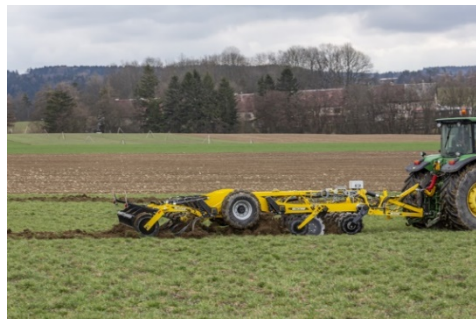
Kombinowany kultywator z dwoma rzędami talerzy roboczych, 660 x 6 mm, oraz dwoma rzędami słupic roboczych zabezpieczonych masywną sprężyną
