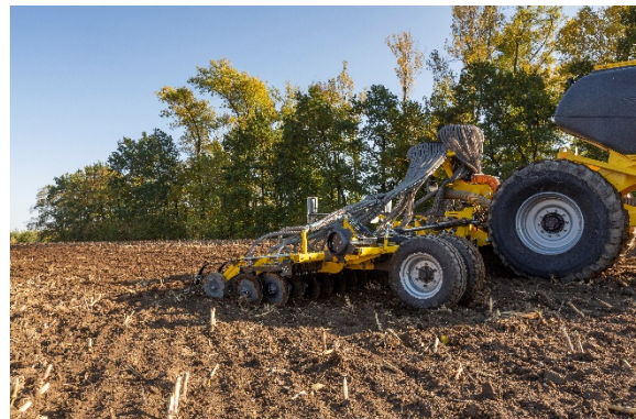
Możliwość hydraulicznej regulacji nacisku i głębokości pracy
