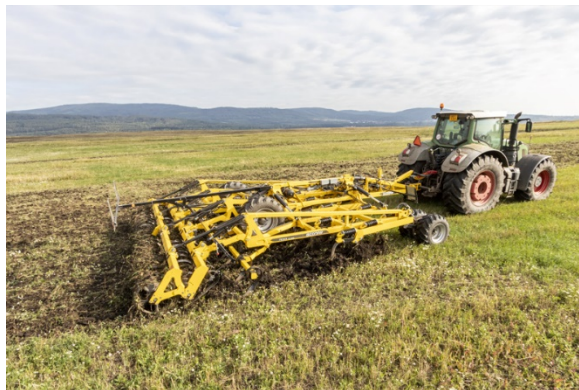
3 lub 4 rzędy elementów roboczych o stałej geometrii z łatwością uprawia glebę
