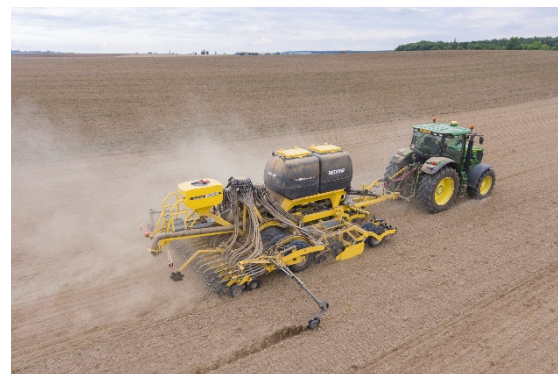
Precyzyjne układanie nasion na identyczną głębokość na całej szerokości maszyny zawdzięczamy systemowi PSP
