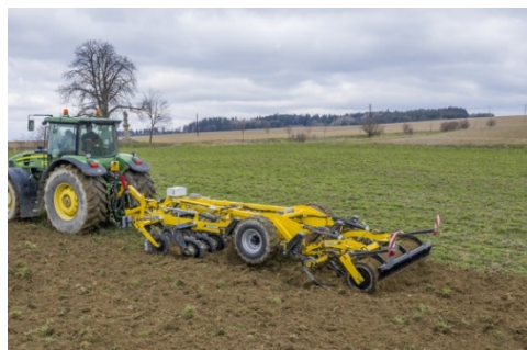
ACTROS RO posiada różne wały doprawiające w zależności od warunków glebowych.
