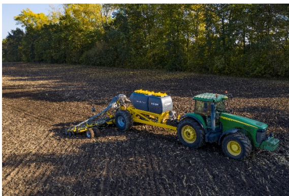
A IV. kategóriás, hárompontos gyorskapcsoló megkönnyíti a COMBO SYSTEM CS túlnyomásos adagolótartály más BEDNAR gépekkel történő összekapcsolását
