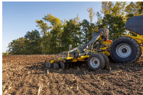
Možnost hydraulického nastavení přítlaku i pracovní hloubky secích botek
