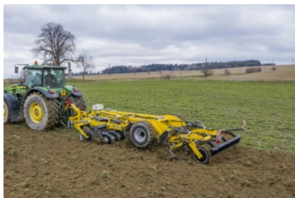
Az ACTROS RO a talajtípusnak/talajviszonyoknak megfelelően hátsó tömörítő eszközzel is felszerelhető.
