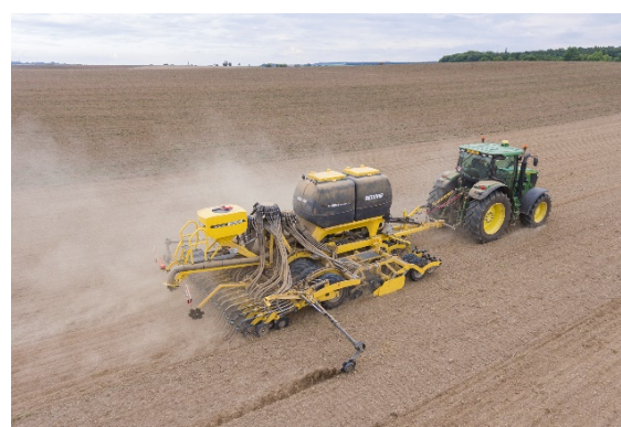
A vetőmag pontos, azonos mélységben történő elhelyezése a gép teljes szélességében, a PSP rendszernek köszönhetően
