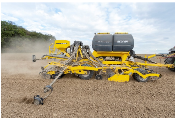
Az új OMEGA OO_FL vetőgép segítségével a műtrágya a sorok közé, vagy a vetőmagokkal együtt is kijuttatható.
