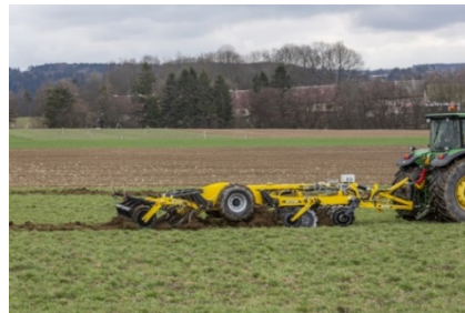
A kombinált kultivátor két 660x6-os tárcsaszorral és két – erős rugós védelemmel biztosított – kapasorral
