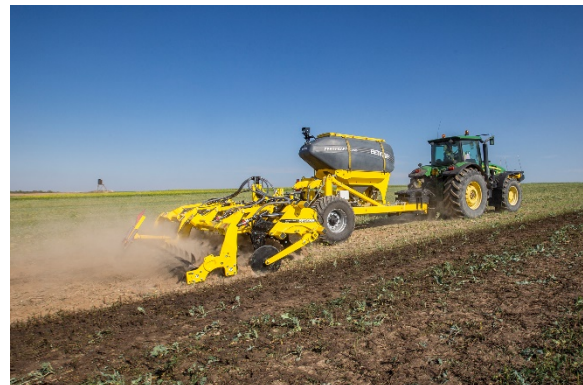
A sávos mélyművelésre kialakított mélylazító és a FERTI-CASRT FC műtrágya-adagoló tartály kombinációja
