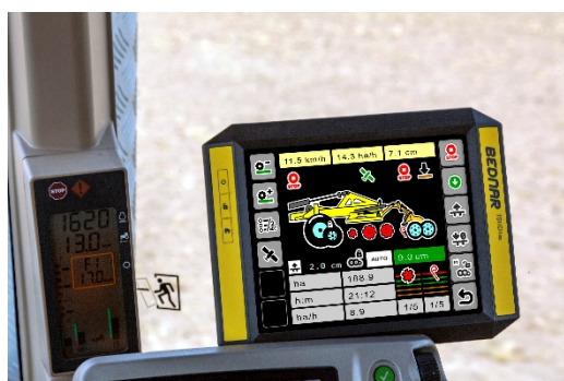
EH-Set elektrohidraulikus gépvezérlés az ISOBUS standard rendszerrel
