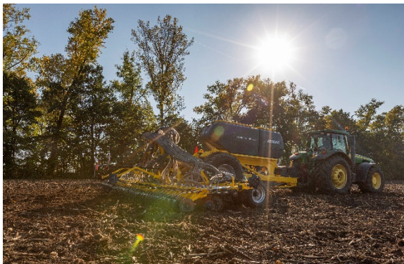
Secí lišta CORSA CN je určená pro agregaci s dvoukomorovým zásobníkem na hnojivo COMBO SYSTEM CS
