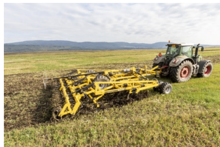
Az állandó geometriai elrendezésű 3 vagy 4 késsor a legszélsebbebb körülmények között is könnyedén
