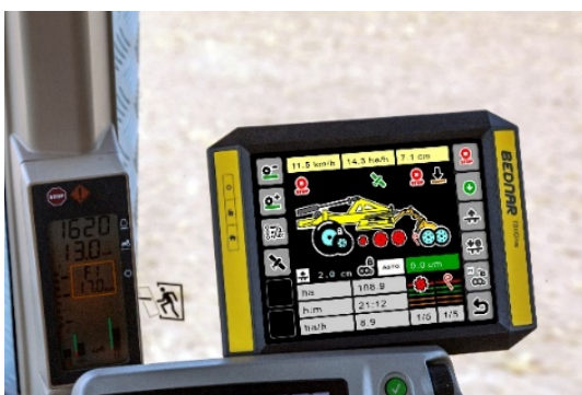
La commande électrohydraulique de la machine (Set-EH) réalisée à l'aide du standard ISOBUS
