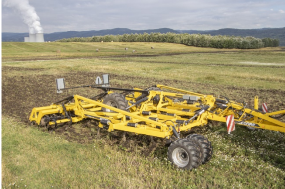
L'essieu intégré permet de pivoter rapidement aux chaintres
