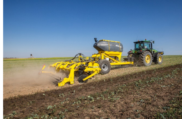
Le décompacteur à dents destiné à travailler le sol en profondeur et en bandes, attelé à une trémie à engrais FERTI-CART FC
