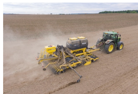
Dépôt précis des graines à une profondeur identique sur toute la largeur de la machine grâce au système PSP
