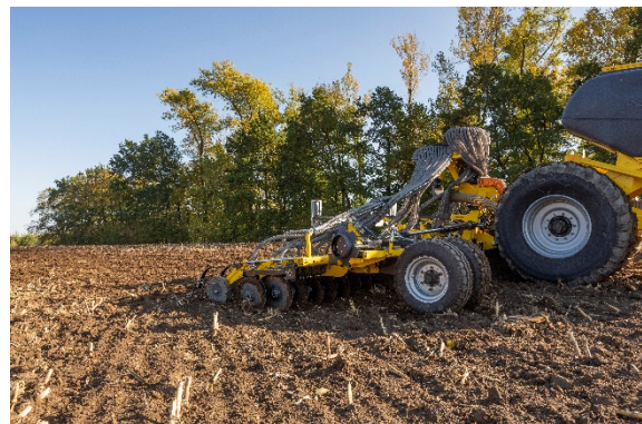
Possibilité de régler hydrauliquement la pression exercée par les sabots et leur profondeur de travail
