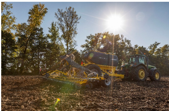
La barre de semis CORSA CN a été conçue pour être associée à une trémie à engrais SYSTÈME COMBO CS à deux compartiments
