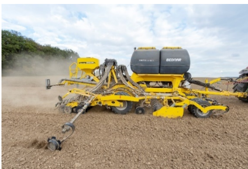
Le nouveau semoir OMEGA OO_FL permet de déposer de l'engrais dans l'inter-rang, entre les graines, ou en même temps que les graines
