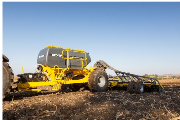
La trémie à deux compartiments, en surpression, attelée à une barre de semis CORSA CN
