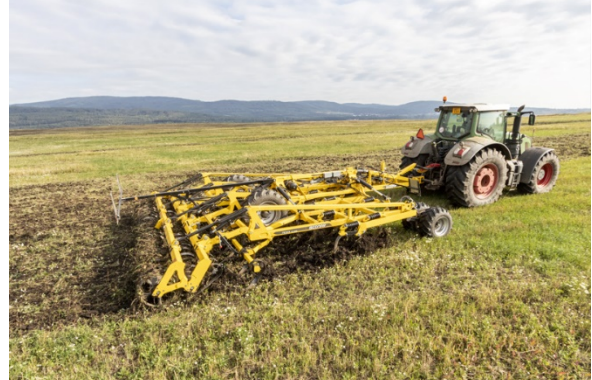
3 ou 4 rangées de socs à géométrie invariable pour faciliter le travail dans des conditions extrêmes
