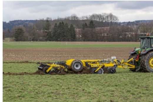
Le cultivateur combiné équipé de deux rangées de disques de 660 x 6 mm et de 2 rangées de socs intégrant une robuste protection par ressort
