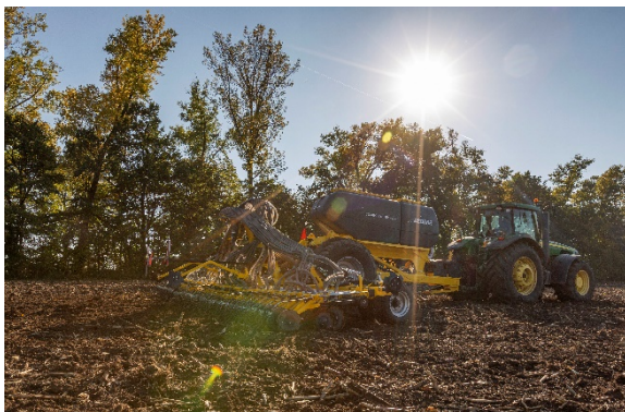
Secí lišta CORSA CN je určena pro agregaci s dvoukomorovým zásobníkem na hnojivo COMBO SYSTEM CS
