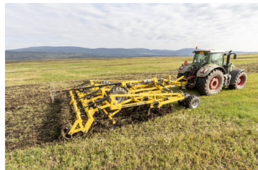
3 oder 4 Scharreihen mit fester Geometrie arbeiten leicht auch in extremen Bedingungen
