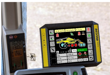
Elektrohydraulische Steuerung EH-Set der Maschine mithilfe des Standards ISOBUS
