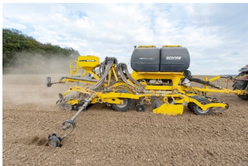
Die neue Drillmaschine OMEGA OO_FL kann den Dünger in eine Zwischenreihe zwischen dem Saatgut oder gemeinsam mit dem Saatgut einbringen.
