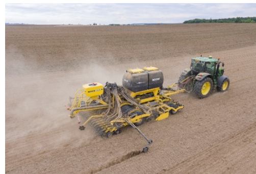
Genaue Einbringung des Saatguts in eine identische Tiefe auf der gesamten Arbeitsbreite der Maschine dank des Systems PSP
