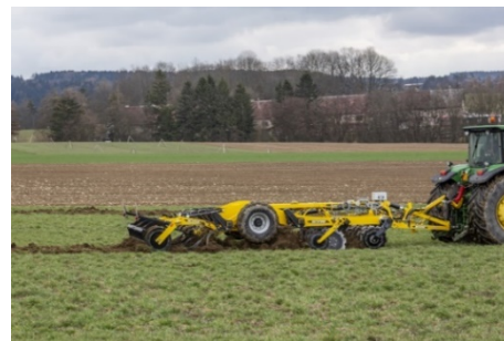
Kombinierter Grubber mit zwei Scheibenreihen 660 x 6 mm und 2 Scharreihen mit starker Federsicherung
