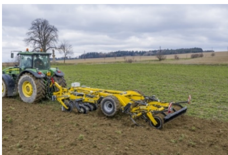
ACTROS RO hat wählbare hintere Packer je nach Bodenbedingungen
