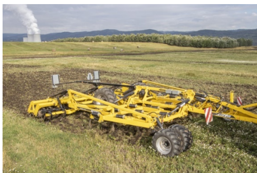
Die integrierte Achse ermöglicht ein leichtes Wenden am Vorgewende
