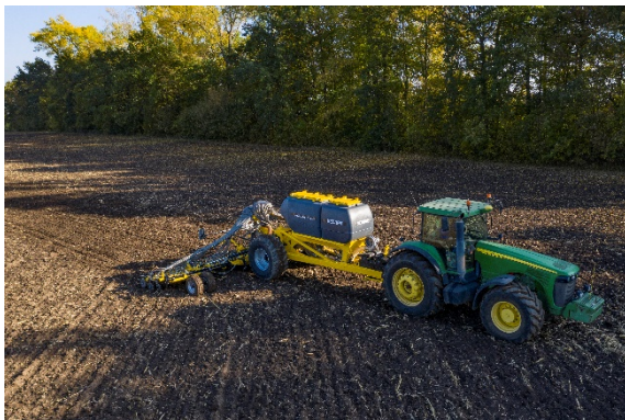
3-Punkt-Aufhängung der IV. Kategorie für einen leichten Zusammenschluss des Überdruckvorratsbehälters COMBO SYSTEM CS mit weiteren Maschinen von BEDNAR
