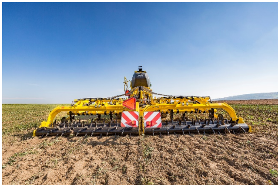
TERRASTRIP ZN 8R/75 ist für eine effektive, gezielte Bodenbearbeitung bestimmt, die die Kosten bei der Ertragssteigerung für die einzelnen Reihenkulturen senkt
