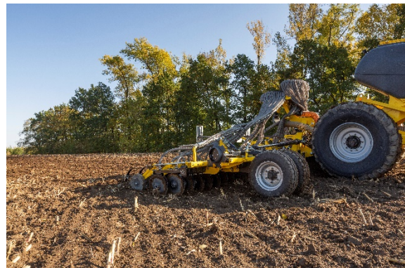
Möglichkeit einer hydraulischen Einstellung des Andrucks und der Arbeitstiefe der Säscharen
