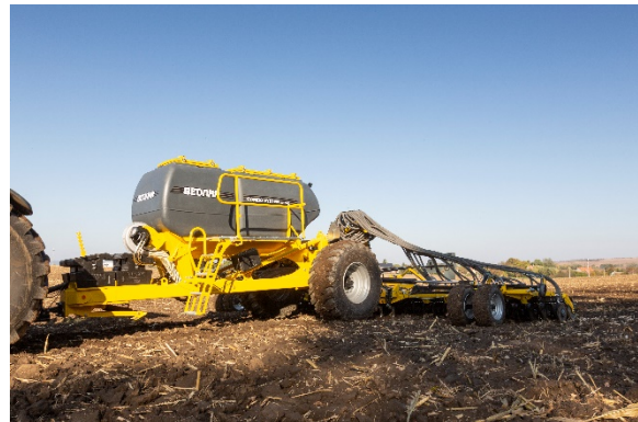
Dvoukomorový přetlakový zásobník agregovaný se secí lištou CORSA CN
