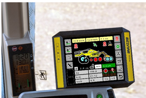
Elektrohydraulické ovládání stroje EH-Set pomocí standardu ISOBUS
