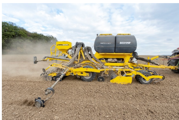
Nový secí stroj OMEGA OO_FL má možnost ukládání osiva do meziřádku mezi osivo nebo společně s osivem
