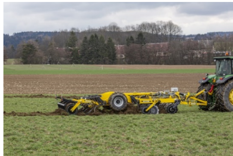
Kombinovaný kypřič s dvěma řadami disků 660 x 6 mm a 2 řadami radlic s mohutným pružinovým jištěním
