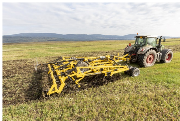
3 nebo 4 řady radlic s pevnou geometrií snadno pracují i v extrémních podmínkách
