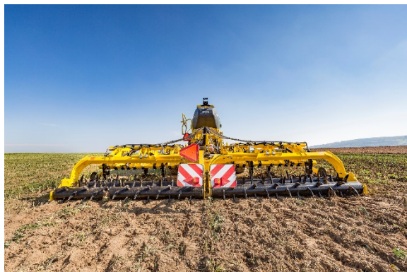
TERRASTRIP ZN 8R/75 je určený pro efektivní, cílené zpracování půdy, které snižuje náklady při zvýšení výnosu jednotlivých řádkových plodin
