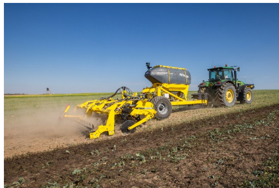
Dlátový pluh pro hloubkové pásové zpracování půdy agregovaný se zásobníkem na hnojivo FERTI-CASRT FC
