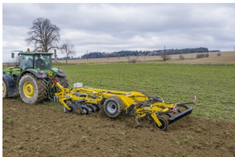
ACTROS RO má volitelné zadní pěchy dle typu půdních podmínek
