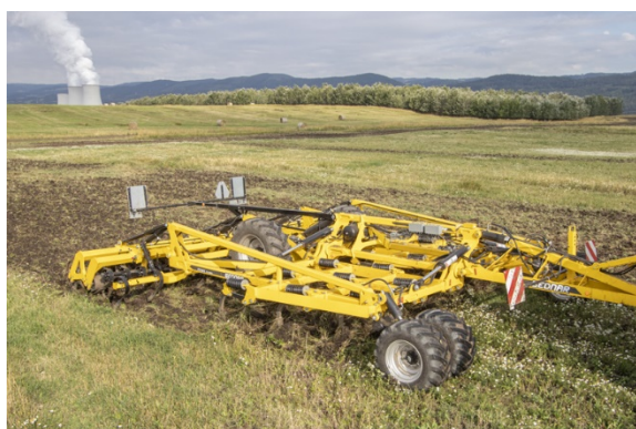
Integrovaná náprava umožňuje rychlé otáčení na souvratích
