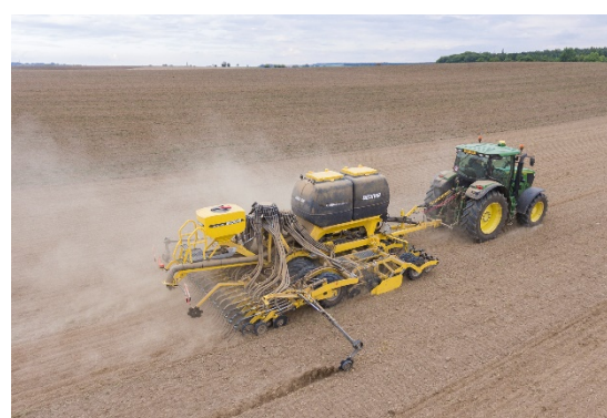
Přesné ukládání osiva do identické hloubky v celé šířce záběru stroje díky PSP systému
