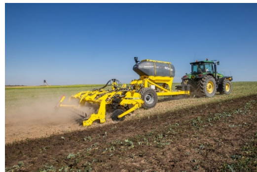
Чизел плуг за култивиране за дълбока лентова обработка, агрегиран с бункер за тор FERTI-CASRT FC
