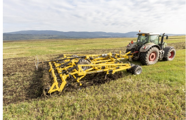
3 или 4 реда лемежи с постоянна геометрия лесно работят дори в екстремни условия
