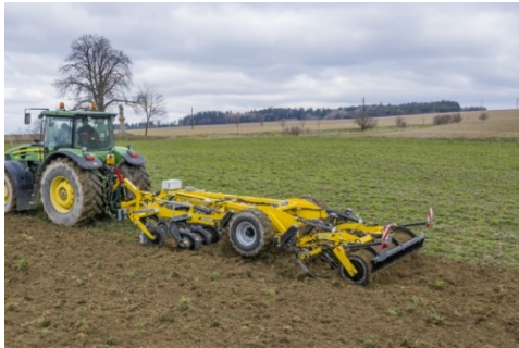
ACTROS RO има опционални задни валяци според типа почвени условия
