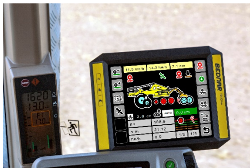
„EH-Set“ - електрохидравлично управление на машината чрез ISOBUS стандарта
