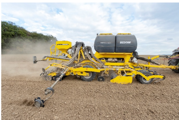
Новата сеялка OMEGA OO_FL може да постави тора в междуредието между семената или заедно със
