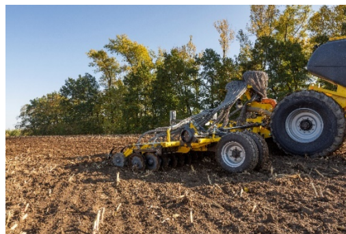
Възможност за хидравлично регулиране на налягането и работната дълбочина на сеитбените ботуши
