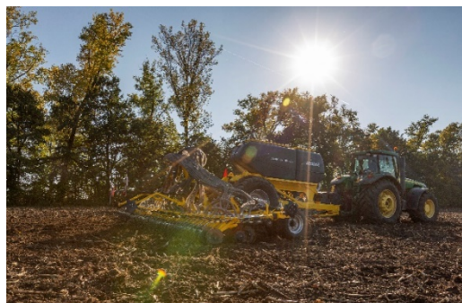
Сеялката CORSA CN е предназначена за агрегиране с двукамерния бункер за тор COMBO SYSTEM CS
