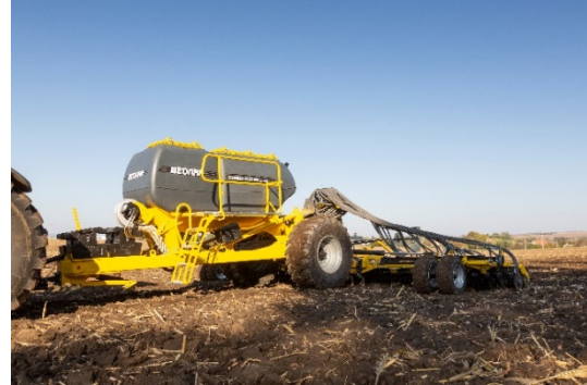
Двукамерен бункер под налягане агрегиран със сеитбена секция CORSA CN
