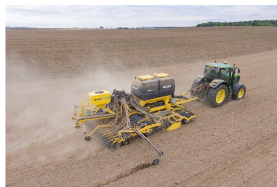
Прецизно поставяне на семена на еднаква дълбочина по цялата ширина на машината благодарение на PSP системата
