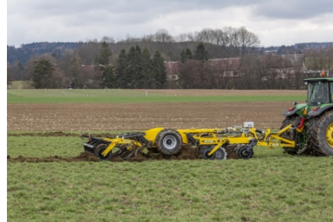
Комбинираният култиватор с два реда дискове, 660 x 6 мм и два реда лемежи с масивна защита на пружината
