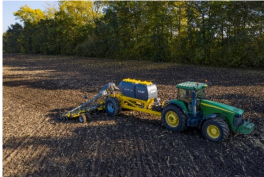
Триточкова навесна система, категория IV за лесно агрегиране на бункера под налягане COMBO SYSTEM CS с други машини BEDNAR
