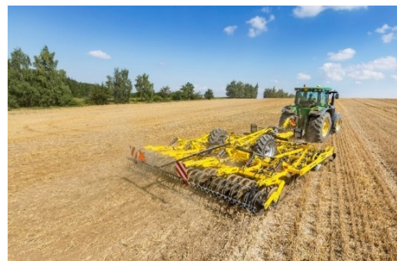
Універсальний культиватор здійснює інтенсивний обробіток стерні на глибину до 15 см - абсолютно рівний зріз профілю ґрунту .
