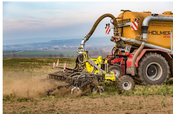
Новинка в портфоліо BEDNAR має окремі робочі органи, що встановлені на паралелограмах
