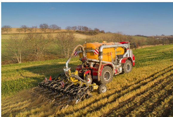
STRIPMASTER EN розрихлює ущільнені шари та вносить добриво у два горизонти
