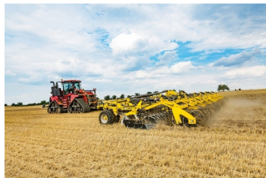
Завдяки ширині 12 м, ATLAS AE_PROFI забезпечує високу щоденну продуктивність та призначений для тракторів з потужністю від 500 кінських сил і вище
