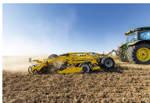
Новий агрегат від Bednar, ATLAS AO_PROFІ, здійснює основний обробіток стерні глибиною в 15 см
