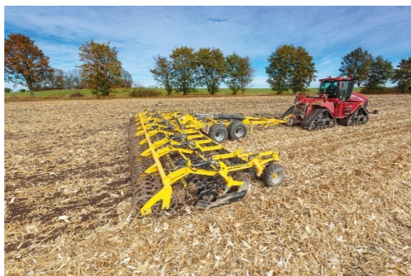
Широкий дисковый культиватор ATLAS AE_PROFI легко обрабатывает большое количество растительных остатков
