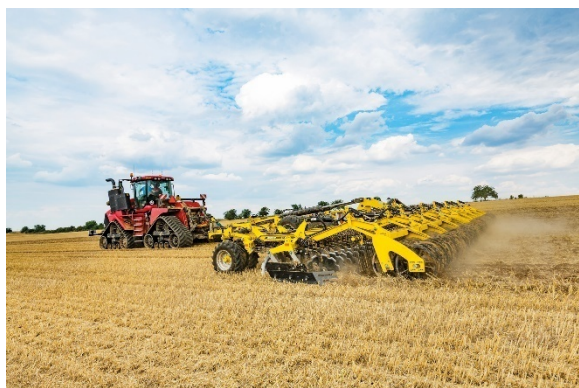
Благодаря ширине в 12 м ATLAS AE_PROFI обеспечивает высокую суточную производительность и рассчитан на тракторы тяговой мощностью 500 лошадей и выше
