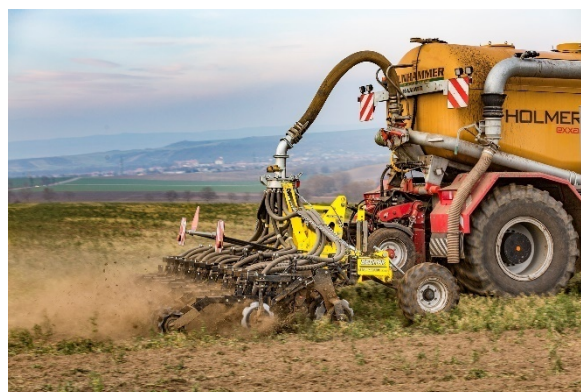
Новинка в ассортименте BEDNAR имеет отдельные рабочие части, смонтированные на параллелограмме
