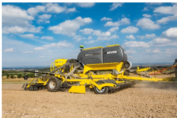
Новая сеялка OMEGA OO_FL позволяет вносить удобрения в междурядье между семенами или вместе с семенами.
