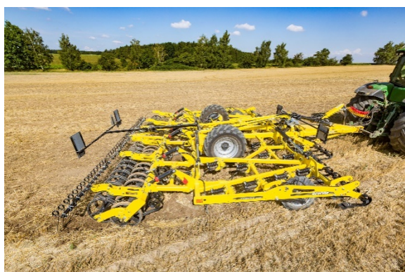
VERSATILL VO_PROFI позволяет работать без задних пакеров
