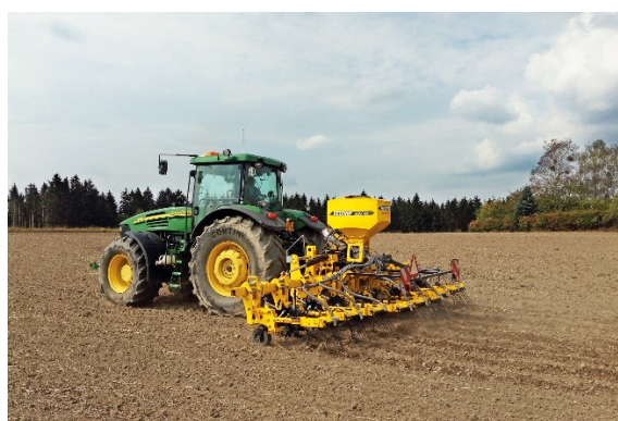
Культиватор ROW-MASTER RN, оборудованный сеялкой ALFA, выполняет междурядные посевы.
