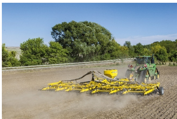
Сеялка ALFA в сочетании с бороной STRIEGEL-PRO PEstraw позволяет осуществлять междурядные посевы и высадку злаковых культур
