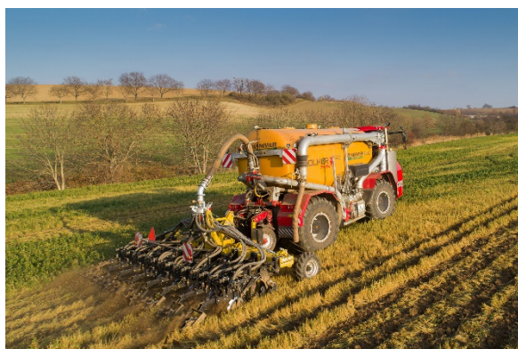
STRIP MASTER EN разрыхляет уплотненные слои и вносит удобрения в два слоя
