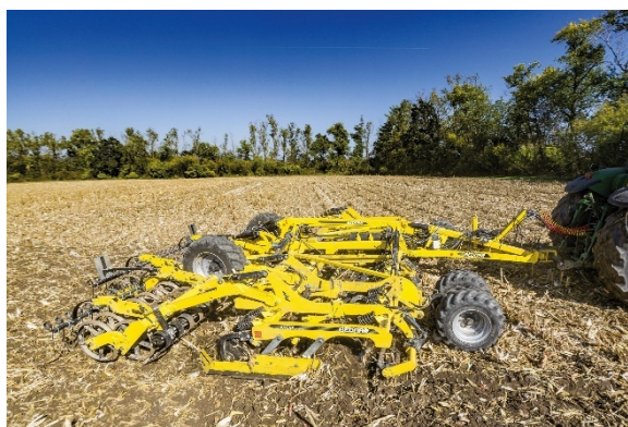
Дисковый культиватор ATLAS AO_PROFI заделывает большое количество остатков кукурузы
