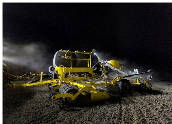
Точное размещение семян на одинаковой глубине по всей ширине машины благодаря системе PSP
