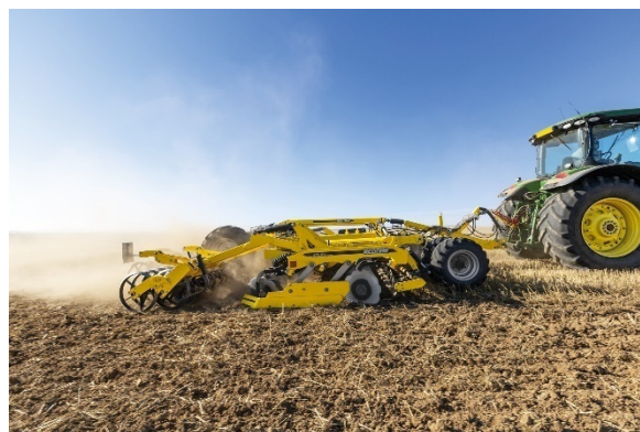
Новая машина Bednar, ATLAS AO_PROFI выполняет луцевку на 15 см в стерне
