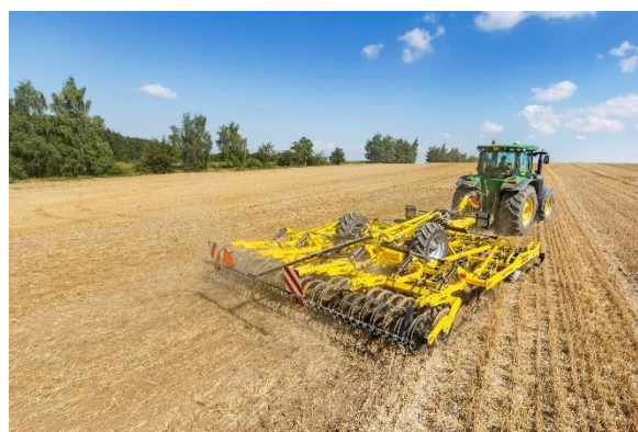
Универсальный культиватор интенсивно возделывает стерню на высоте до 15 см, создавая абсолютно ровное дно почвенного профиля.
