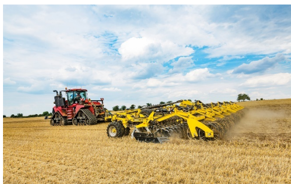
Dzięki szerokości 12 m, ATLAS AE_PROFI zapewnia wysoką dzienną wydajność. Konstrukcja maszyny przeznaczają ją do traktorów 500 KM i więcej.
