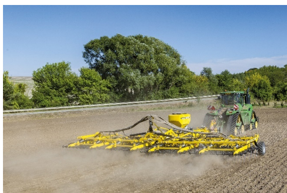
ALFA DRILL w kombinacji z broną do słomy STRIEGEL-PRO PE, podczas siewu trawy
