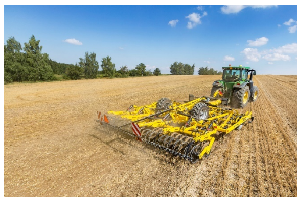
Uniwersalny kultywator podczas kultywacji do 15 cm głębokości – całkowite podcięcie profilu glebowego
