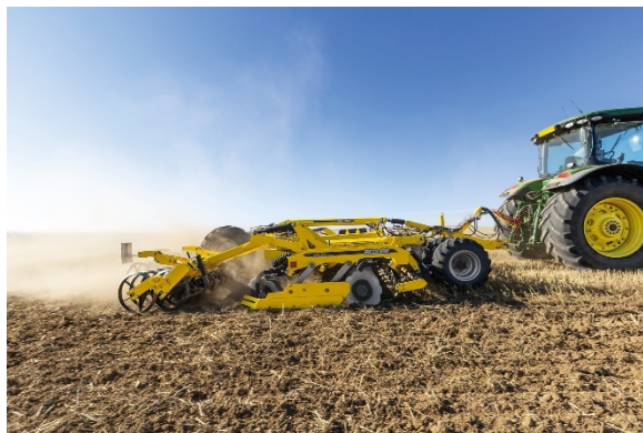
Nowy ATLAS AO_PROFI Bednar zapewnia kultywację ścierniska do 15 cm
