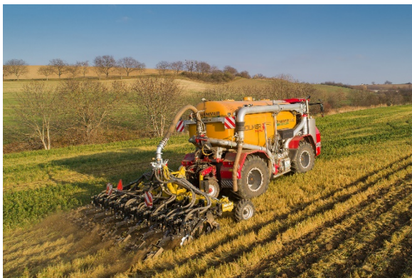
STRIP MASTER EN usuwa zbite warstwy ił uклада nawóz na dwóch poziomach
