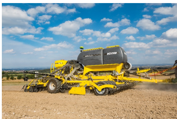
Nowy siewnik OMEGA OO_FL daje możliwość siewu nawozu w międzyrzędziu pomiędzy nasionami lub wraz z nasionami.
