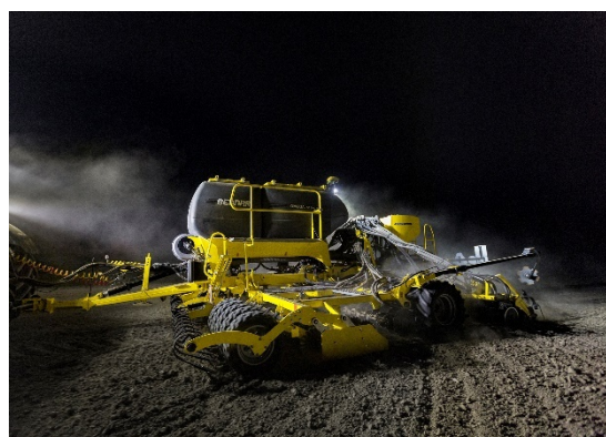
Precyzyjne układanie nasion na identyczną głębokość na całej szerokości maszyny, dzięki systemowi PSP.
