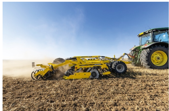
Új, ATLAS AO_PROFI nevű gépünk 15 cm-es művelési mélységben végez tarlólántást
