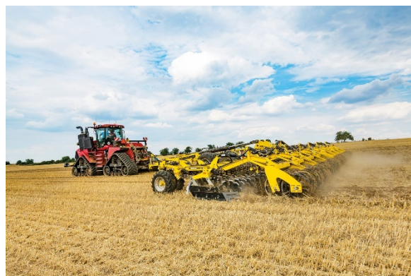
A legalább 500 lóerős traktorokhoz tervezett, 12 méteres munkaszélességű ATLAS AE_PROFI segítségével hatalmas napi teljesítmények érhetők el
