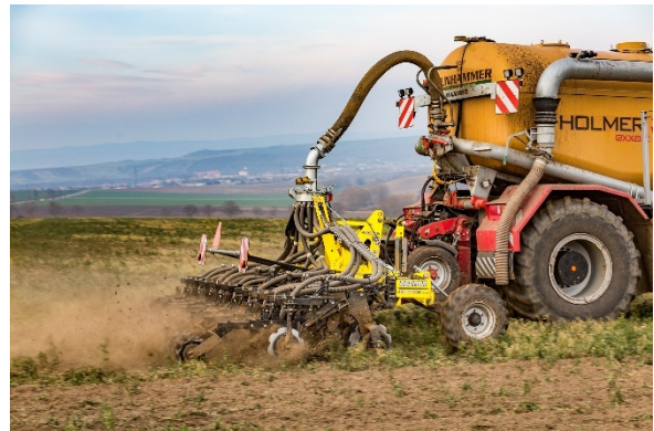
A BEDNAR kínálatának újdonsága, hogy a munkaeszközöket paralelogramma alakú vázra szereltük
