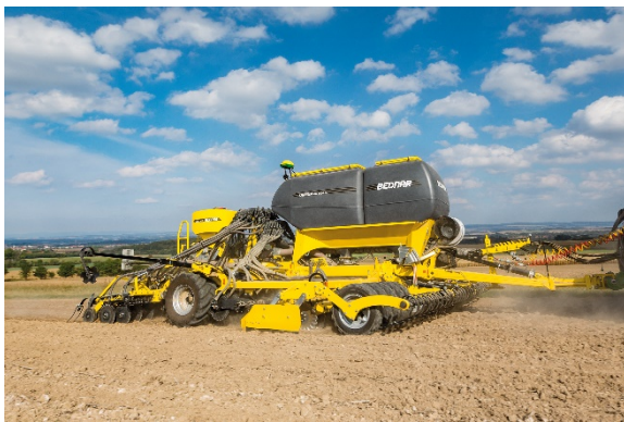
Az új OMEGA OO_FL vetőgép segítségével a tápanyag-utánpótlás a sorok közé, vagy a vetőmagokkal együtt is kijuttatható.
