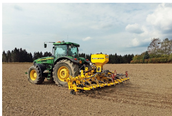
Köztes védőnövény telepítése az ALFA DRILL egységgel kiegészített ROW-MASTER RN kultivatórral
