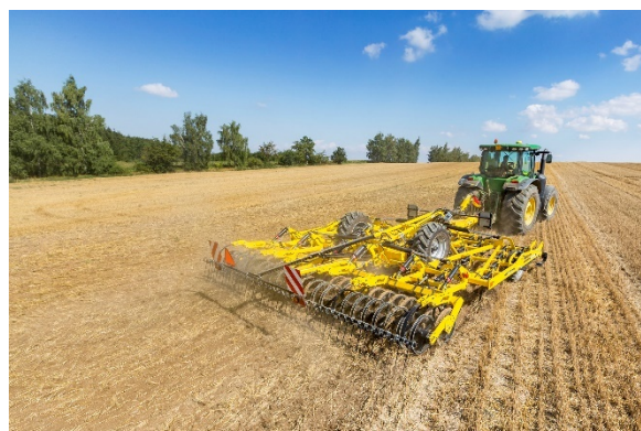
Az univerzális kultivátor intenzív tarlóművelést végez 15 cm mélységig – a megmunkált réteg alatt teljesen egyenletes talajfelszínt hagyva maga után
