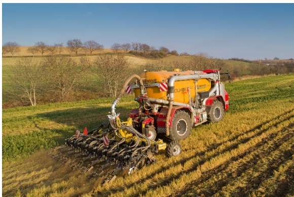
A STRIP MASTER EN fellazítja a tömörödött talajrétegeket, és két rétegben juttatja ki a műtrágyát
