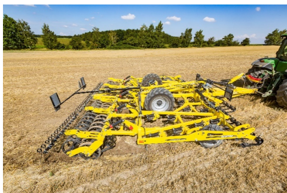
A VERSATILL VO_PROFI a hátsó tömítőhengerek nélkül is használható
