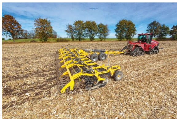
A különösen nagy munkaszélességű ATLAS AE_PROFI tárcsás talajművelő géppel nagy mennyiségű szármagmaradvány kezelése sem jelent gondot
