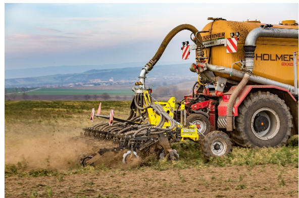
Une nouveauté dans le portefeuille des machines de marque BEDNAR comporte les unités de travail individuelles suspendues sur un élément en parallélogramme.
