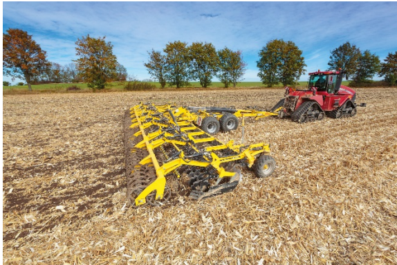
Le déchaumeur à disques à grande largeur de travail ATLAS AE_PROFI traite sans problèmes une grande quantité de résidus post-récolte
