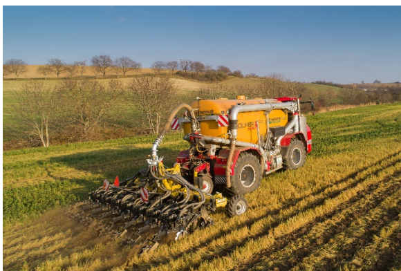
Le cultivateur à socs STRIP MASTER EN rompt la couche de sol compactée et en même temps dépose l'engrais en deux couches
