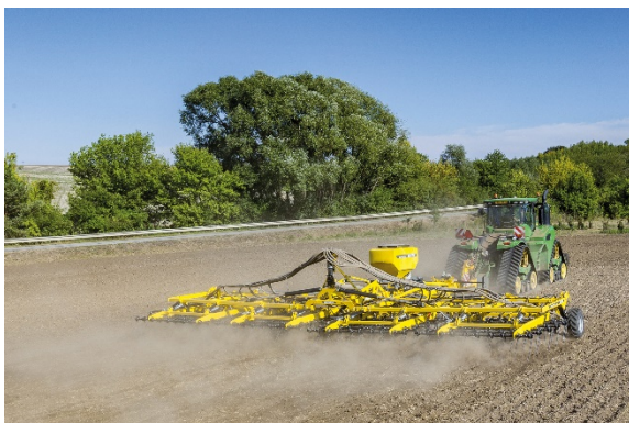
L'unité de semis ALFA DRILL en combinaison avec les herse de champ STRIEGEL-PRO PE est capable de réaliser le semis des plantes intermédiaires ou des graminées
