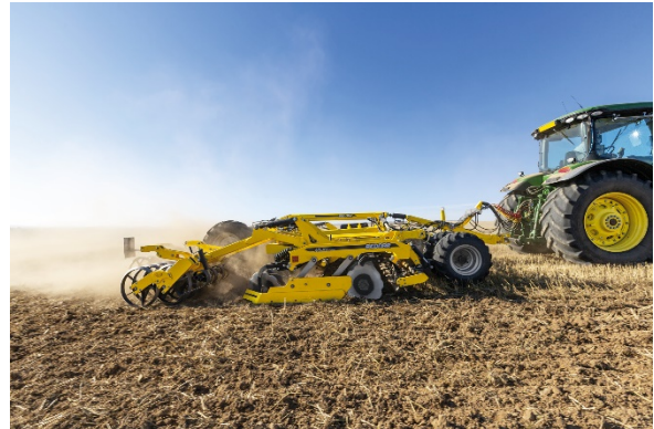
Une nouveauté de la société BEDNAR, ATLAS AO_PROFI réalise le déchaumage jusqu'à 15 cm sur le chaume
