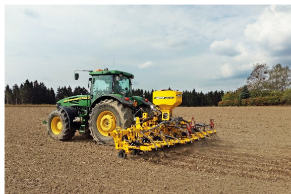
La bineuse entre rangs ROW-MASTER RN équipée de l'unité de semis ALFA DRILL sème les plantes intermédiaires
