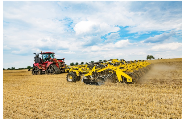
Grâce à la largeur de travail de 12 m, ATLAS AE_PROFI possède d'excellents rendements journaliers et il est destiné aux tracteurs avec la puissance de traction 500 chevaux et plus
