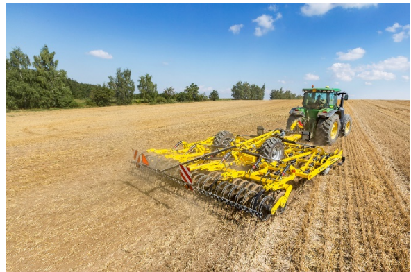
Le déchaumeur polyvalent réalise un déchaumage intensif du chaume jusqu'à 15 cm – un fond absolument plat du profil de sol
