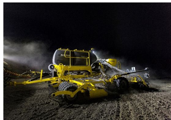
Le dépôt précis des grains dans une profondeur identique sur toute la largeur de travail de la machine grâce au système PSP
