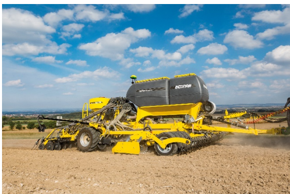
Le nouveau semoir OMEGA OO_FL a la possibilité de déposer les grains entre les rangs entre les grains ou bien ensemble avec les grains
