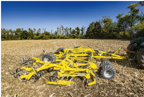
Le déchaumeur à disques ATLAS AO_PROFI enfouit une grande quantité de résidu post-récolte de maïs
