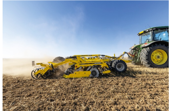
Die Neuigkeit von BEDNAR, die Maschine ATLAS AO_PROFI, bricht das Stoppelfeld bis zu einer Tiefe von 15 cm auf
