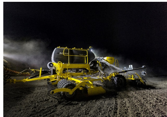
Genau Ablage des Saatguts in eine gleichbleibende Tiefe auf der gesamten Arbeitsbreite der Maschine dank des Systems PSP
