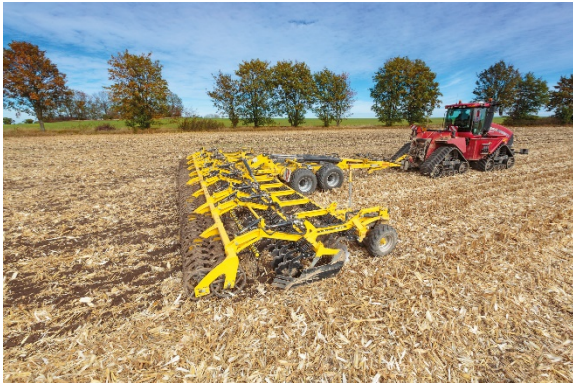
Die Scheibenegge ATLAS AE_PROFI mit breitem Arbeitsbereich verarbeitet problemlos größere Mengen von Ernterückständen
