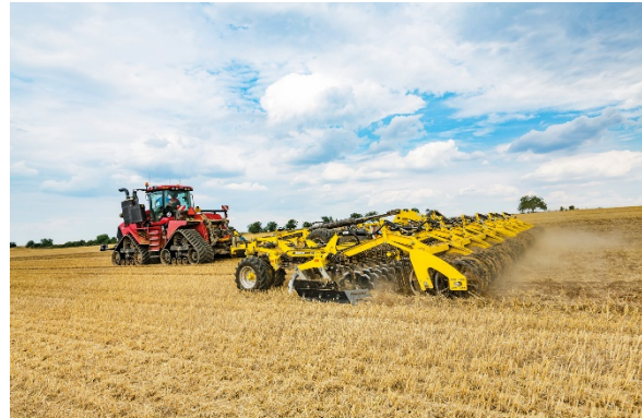
ATLAS AE_PROFI hat dank einer Arbeitsbreite von 12 m große Tagesleistungen und ist für Traktoren mit einer Zugleistung von mindestens 500 PS bestimmt
