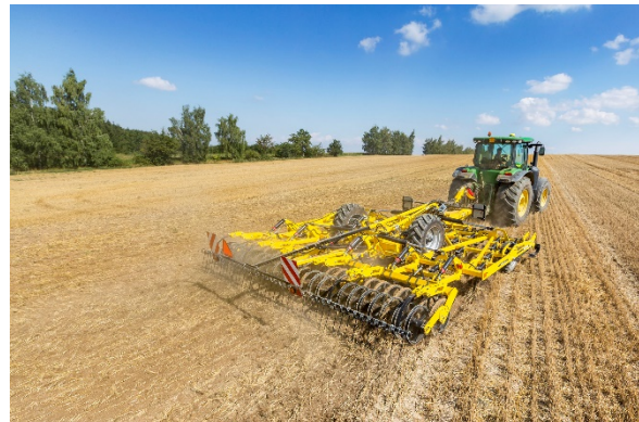
Der Universalgrubber besorgt einen intensiven Umbruch des Stoppelfelds bis 15 cm – mit einer absolut geraden Sohle des Bodenprofils
