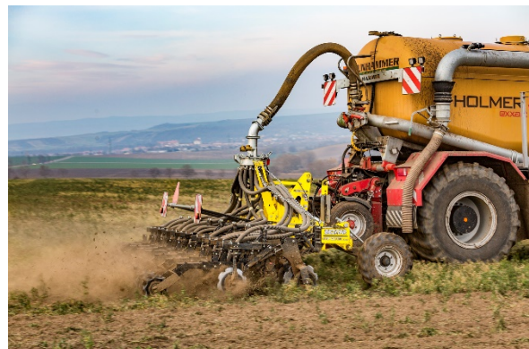
Die Neuigkeit im Maschinenangebot von BEDNAR hat getrennte, Arbeitseinheiten in Parallelogrammaufhängung
