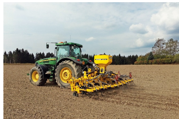
Das Reihenhackgerät ROW-MASTER RN mit aufgebautem ALFA DRILL sät Zwischenfrüchte
