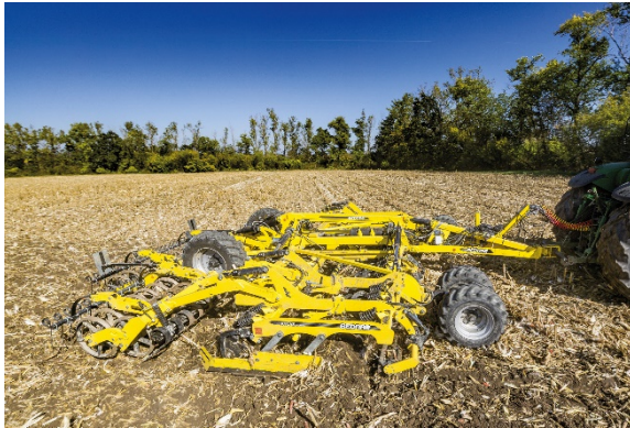
Die Scheibenegge ATLAS AO_PROFI arbeitet eine große Menge von Ernterückständen von Mais ein
