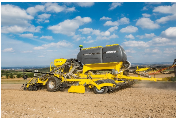
Die neue Drillmaschine OMEGA OO_FL ermöglicht eine Einbringung von Dünger in die Zwischenreihen zwischen die Saat oder auch gemeinsam mit dieser
