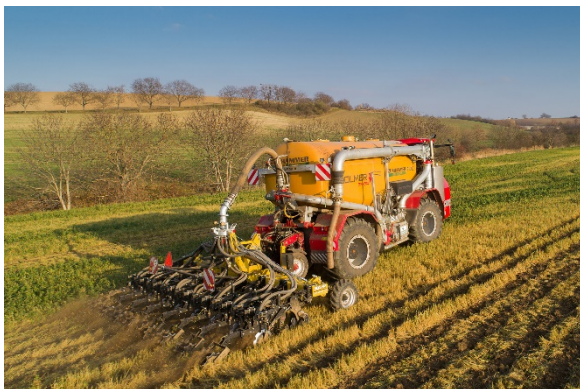
Das Reihenhackgerät STRIP MASTER EN bricht verfestigte Schichten auf und bringt gleichzeitig Dünger in zwei Höhengniveaus ein
