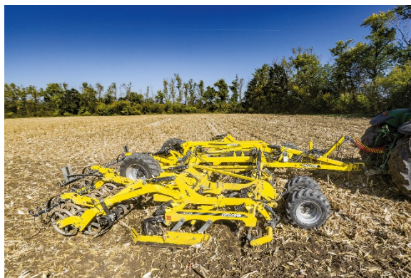
Diskový podmítač ATLAS AO_PROFI zapravuje velké množství posklizňových zbytků kukuřice
