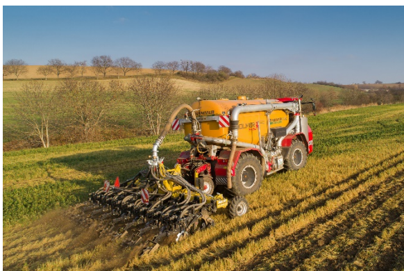
Řádkový kypřič STRIP MASTER EN narušuje utužené vrstvy a zároveň ukládá hnojivo do dvou vrstev
