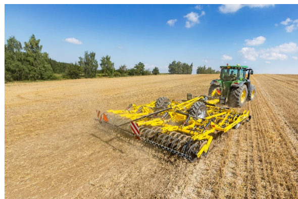
Univerzální kypřič provádí intenzivní podmínku strniště do 15 cm – absolutně rovné dno půdního profilu
