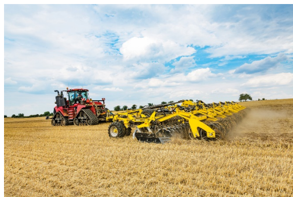
ATLAS AE_PROFÍ díky záběru 12 m má vysoké denní výkony a je určený pro traktory s tažnou silou 500 koní a více
