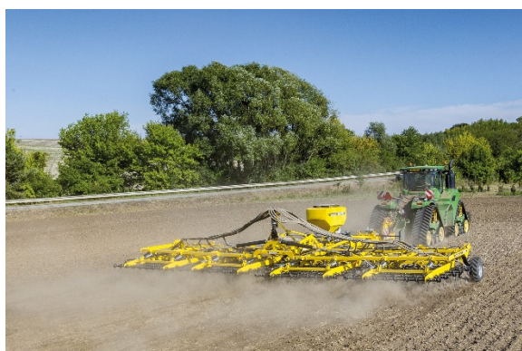
Secí jednotka ALFA DRILL v kombinaci s polními branami STRIEGEL-PRO PE zvládá výsev meziplodin nebo travin
