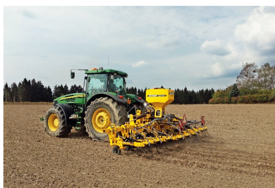
Meziřádkový kypřič ROW-MASTER RN osazený secí jednotkou ALFA DRILL vysévá meziplodiny
