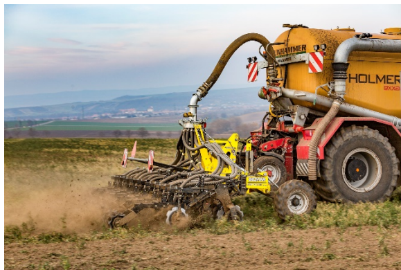
Novinka v portfoliu strojů značky BEDNAR má individuální pracovní jednotky uloženy na paralelogramu
