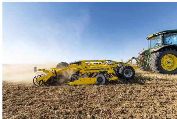
Novinka společnosti BEDNAR, ATLAS AO_PROFI provádí podmítku do 15 cm ve strništi
