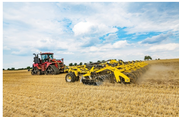
Благодарение на ширината от 12 м, ATLAS AE_PROFI осигурява високи дневни норми и е предназначен за трактори с мощност от 500 к.с. и повече.
