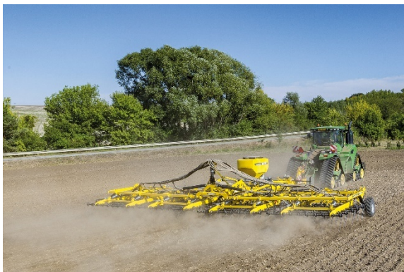
ALFA DRILL в комбинация с брана за слама STRIEGEL-PRO PE за сеитба на междинни култури или тревни смеси.
