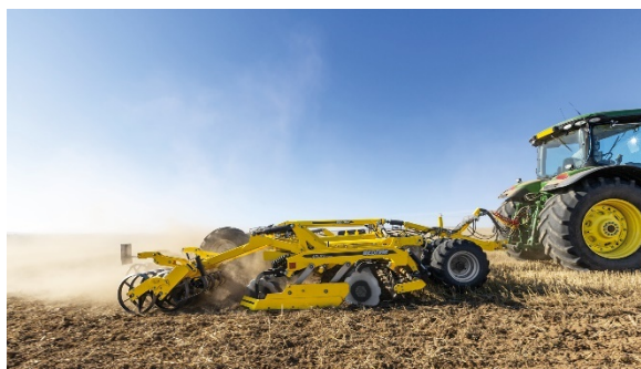
Новата BEDNAR машина ATLAS AO_PROF1 може да извършва култивиране на полето при 15 см височина на стърнището.
