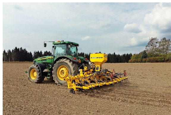
Култиваторът ROW-MASTER RN оборудван с ALFA DRILL за сеитба на междинни култури.
