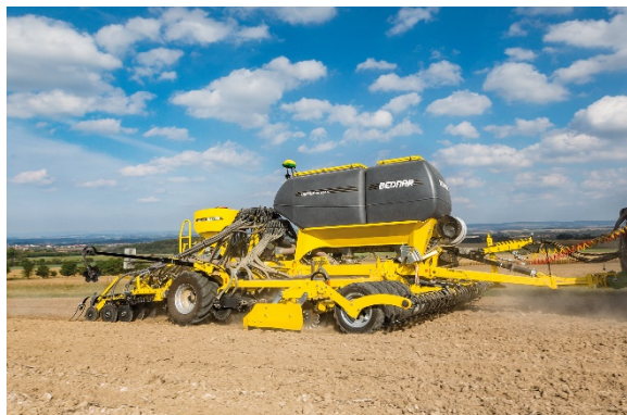
Новата сеялка OMEGA OO_FL има възможността да поставя тор в междуредовото разстояние между семената или заедно с тях
