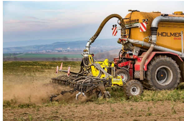
Новостта в портфолиото на BEDNAR е индивидуалните работни секции окачени на паралелограм
