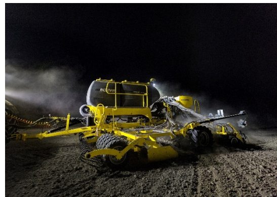
Прецизно полагане на семената на еднаква дълбочина по цялата работна ширина на машината, благодарение на PSP системата за натиск.
