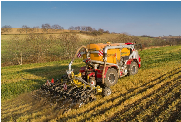
STRIP MASTER EN разбива уплътнените слоеве и доставя тор на две нива.
