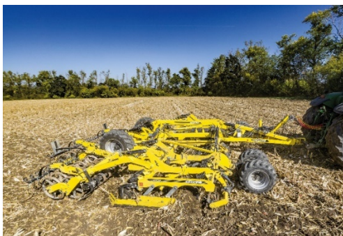
Дисковият култиватор ATLAS AO_PROF1 може да се справи със смесването на голямото количество от царевични остатъци
