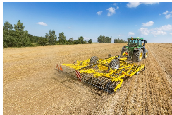
Универсалният култиватор извършва интензивно стърнищно култивиране до 15 см – абсолютно изравнено дъно на почвения профил
