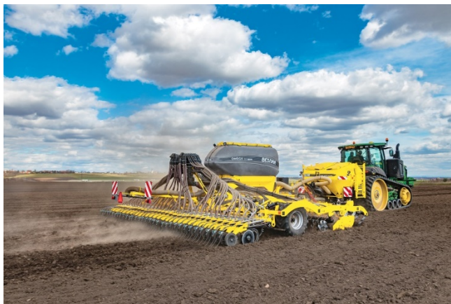
Сеялка OMEGA OO 8000 L в сцепке с FERTI-BOX FB, бункером для удобрений
