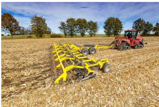
Широкий дисковый культиватор ATLAS AE 12400 для увеличенной ежедневной выработки
