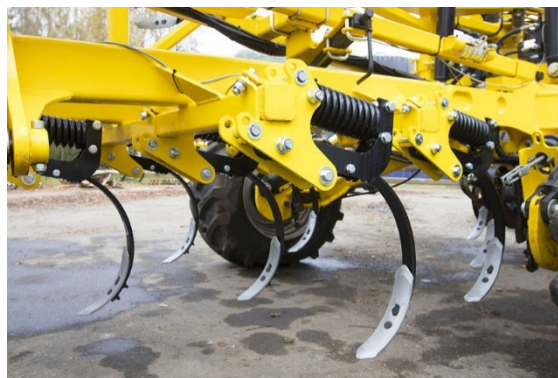
ЛЕМЕХИ С НЕПРЕРЫВНОЙ ЗАЩИТОЙ во время предпосевной и пожнивной обработки до 15 см в тяжелых условиях
