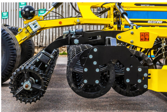
Кольчато-зубчатый каток – третий каток подобного типа в серии Swifter SO_PROFI. Данная модель была разработана специально по просьбе фермеров, занимающихся выращиванием сахарной свеклы, для улучшенного финального уплотнения почвы прямо перед посадкой
