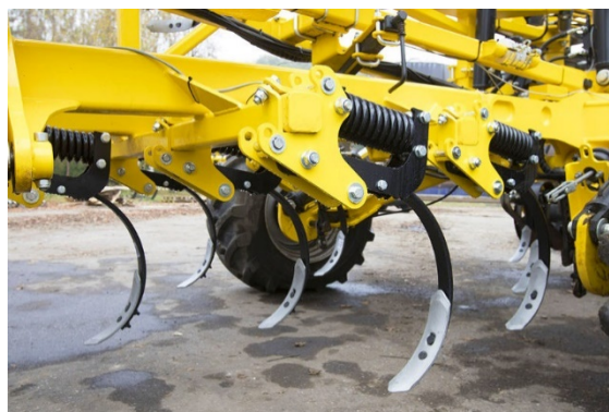
A NON-STOP rugós biztosítású kapák 15 cm mély tarlóhántásra is használhatók
