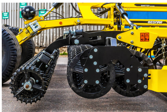
A Finish crosskill a harmadik sor crosskill henger a SWIFTER SO_PROFI kompaktorokon. Ennek az opciónak az előnyeit elsősorban cukorrépa-termelők fogják tudni hasznosítani.
