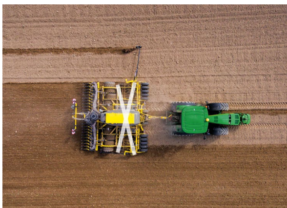
Az OMEGA OO_L tárcsás egysége „X” alakba van rendezve. Ez a műszaki megoldás kiküszöböli az oldalirányú elmozgásokat
