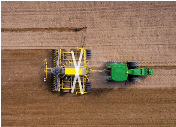
Le semoir OMEGA OO_L est équipé de sections de disques agencés en « X » afin que le semoir suive parfaitement les traces du tracteur
