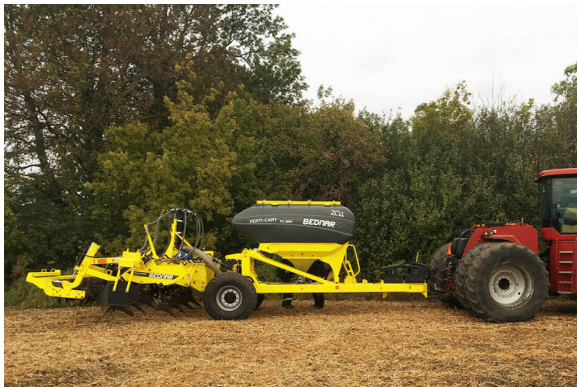
La machine FERTI-CART FC3500 attelée à une machine TERRASTRIP ZN/8R
