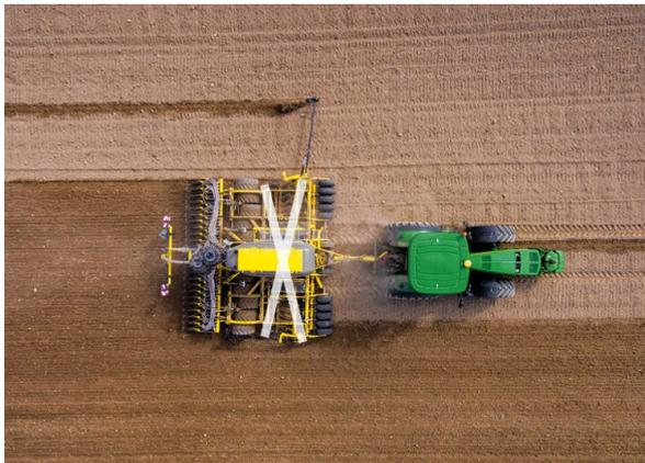
*Die Sämaschine OMEGA OO\_L hat in X-Form angeordnete Scheibensektionen, wodurch ein exaktes Halten der Spur der Sämaschine hinter dem Traktor gewährleistet wird.*
