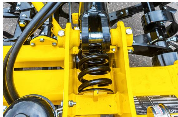
*Die Arbeitsrahmen der Sektionen der Maschine Swifter SO\_PROFI sind mit Federn zwischen den seitlichen Rahmen und dem Hauptrahmen befestigt. Diese patentierte Lösung ermöglicht mit der Maschine eine hohe Arbeitsgeschwindigkeit bis zu 15km/h*
