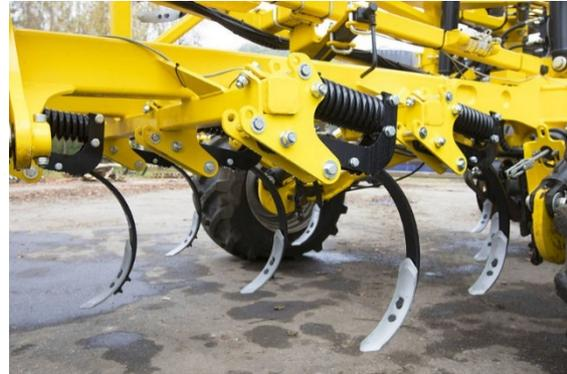
*Schare mit NON-STOP-SICHERUNG für Saatbettbereitung Einarbeitung von Ernterückständen bis zu einer Tiefe von 15 cm bei schweren Bodenverhältnissen*
