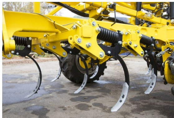
Radličky s NON-STOP jištěním pro předseťovou přípravu a podmítky až do 15 cm v těžších podmínkách
