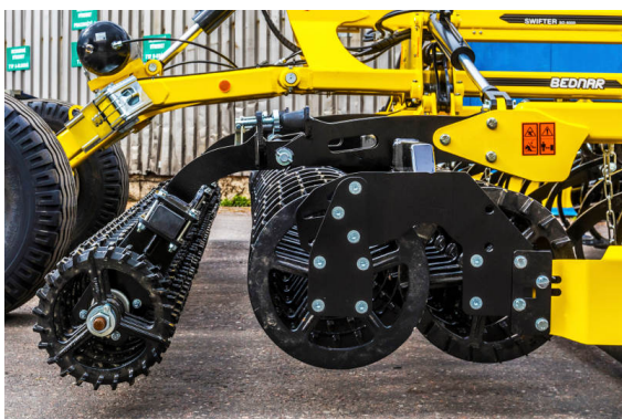
Finish croskill je třetím croskillem v řadě na stroji SWIFTER SO_PROFI. Pěstitelé cukrové řepy si toto řešení vyžádali pro lepší finální konsolidaci seťového lůžka těsně před setím
