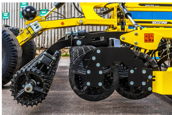
Крайният валеж cross-kill е третият по ред cross-kill при Swifter SO_PROFI серията. Производителите на захарно цвекло настояваха за това решение за по-добро уплътняване на семенното легло непосредствено преди сеитбата.
