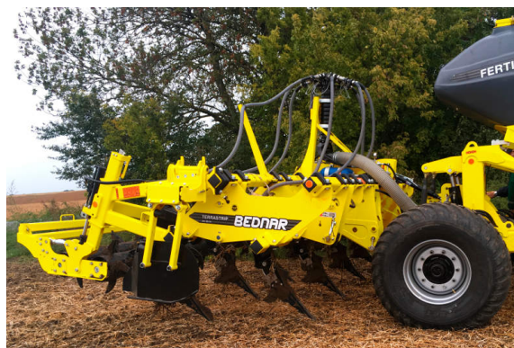
TerraStrip w kombinacji z Ferti-Cart FC 3500 przeznaczonych do nawożenia profilu glebowego
