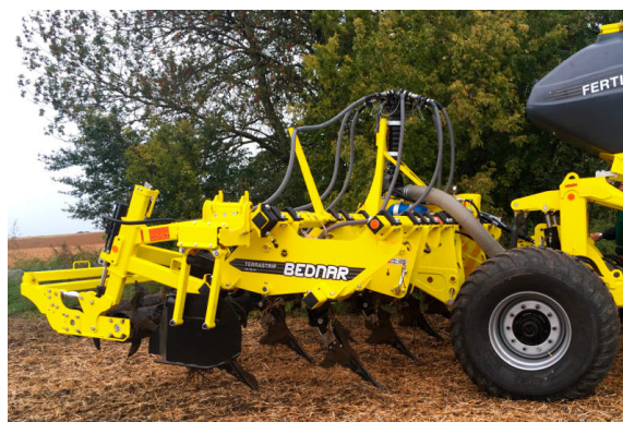
TerraStrip ve spřažení s Ferti-Cart FC 3500 určený pro profilové hnojení
