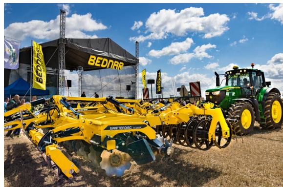
La machine SWIFTERDISC XO 6000F équipée d'un disque coupant avant
