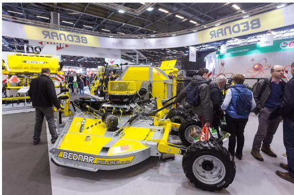
*Broyeur Mulcher MZ 4500 équipé d'un Trash-Fan qui empêche les résidus végétaux de se déposer sur la machine*
