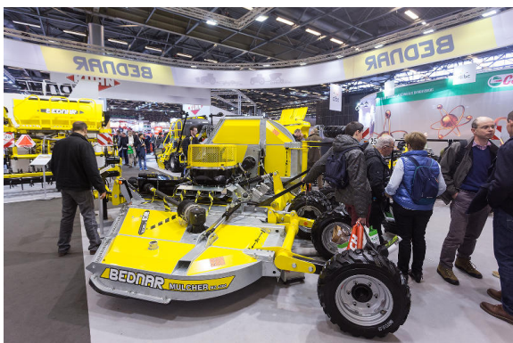
Mulcher MZ 4500 mit Trash-Fan gegen das Ablagern von Pflanzenrückständen
