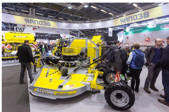
Mulcher MZ 4500 s Trash-Fanem proti usazování rostlinných zbytků
