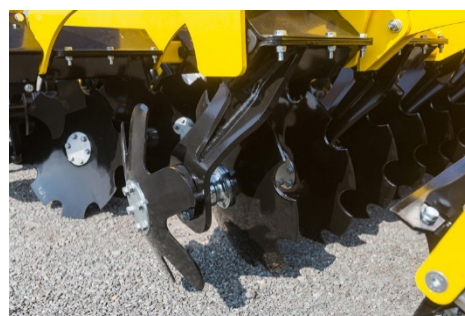
Винтовые соединения между дисками, подшипниковыми коробками и стойками защищены от нежелательного рыхления с помощью antivибрационных шайб
