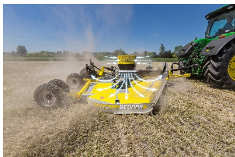
Вентилятор для удаления мусора предназначен для мульчирователя послеуборочных остатков и имеет ширину от 4,5 до 7 метров
