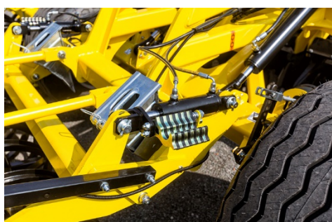
Быстрая установка рабочей глубины с помощью установочных шайб на гидравлических цилиндрах
