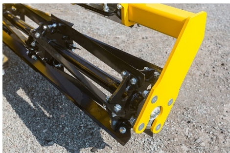
Измельчитель сорной растительности и послеуборочных остатков предназначен для дисковых культиваторов SWIFTERDISC XO_F и бороны для соломы STRIEGEL-PRO
