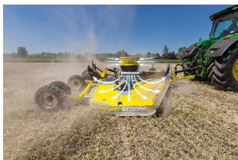
Trash-Fan jest przeznaczony do mulcerów o szerokościach od 4,5 do 7 metrów
