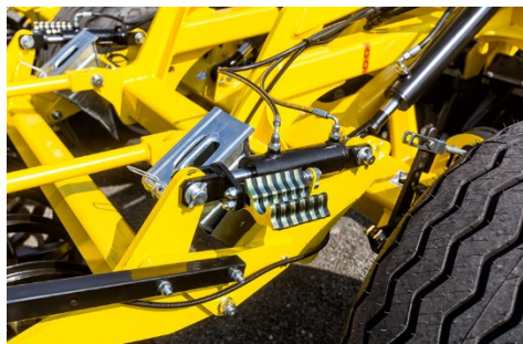
Szybka regulacja głębokości pracy poprzez klipsy na siłowniku hydraulicznym
