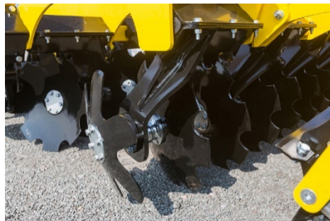
Śruby pomiędzy dyskami, obudowami łożysk i słupkami zostały wyposażone w podkładki antywibracyjne
